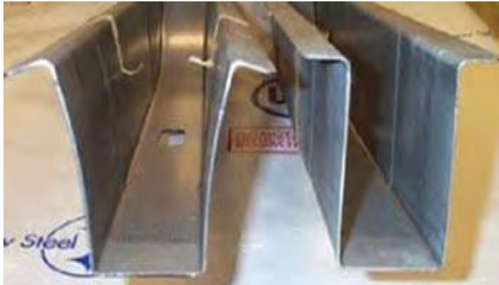
Obrázek 21: Porovnání odpružení vysokopevnostních ocelí (vlevo) vůči běžným ocelím (vpravo) [32]
