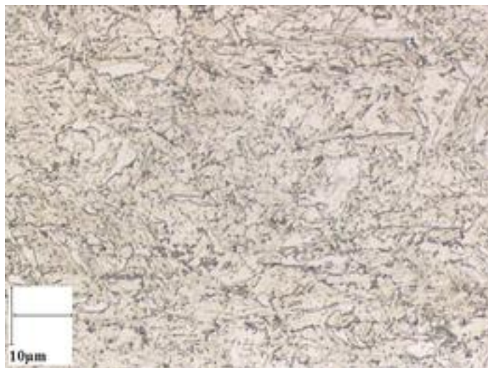
Obrázek 13: Feriticko-bainitká mikrostruktura CP oceli (ocel Complex Phase 1000) [21]
