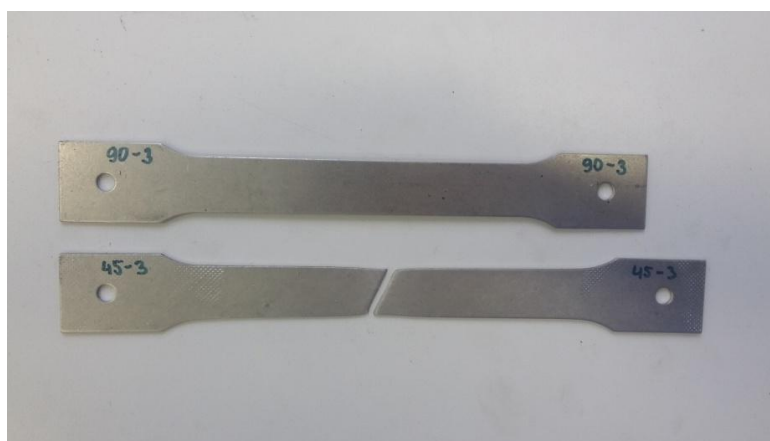
Obrázek 25: Snímek dvou vzorků, 90-3 před zkouškou, 45-3 po zkoušce
