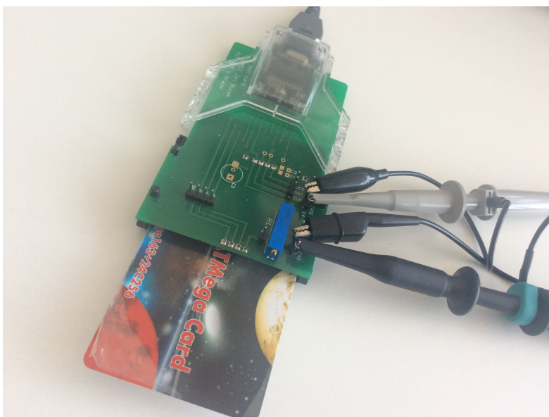
Obrázek 3.6: Měřící zařízení s napojenými sondami z osciloskopu
