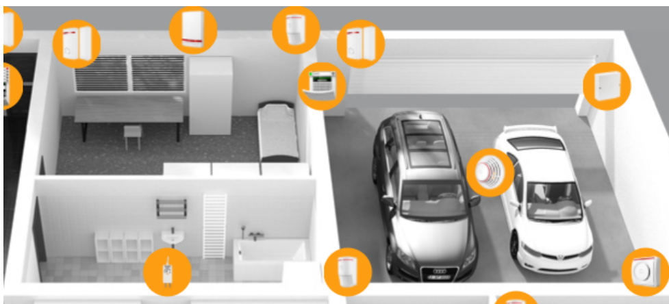
Obrázek 1.2: Modulární zabezpečovací systém Jablotron v rodinném domě [2]. Všechny žluté komponenty jsou připojeny do jednoho ovládacího modulu.
