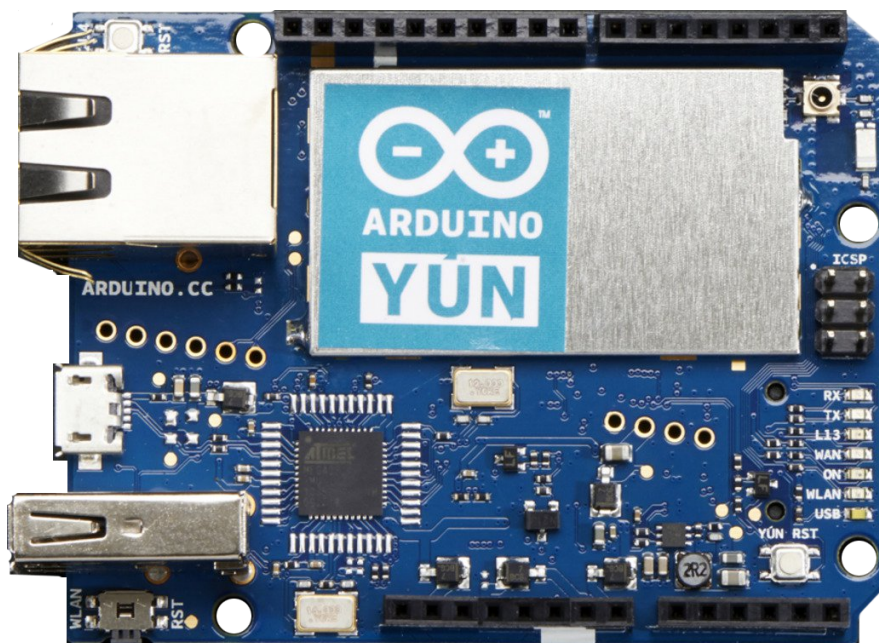
Obrázek 2.5: Vybraná vývojová deska – Arduino Yún [14].
