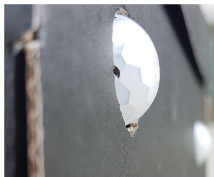
Obrázek B.6: Detail PIR
