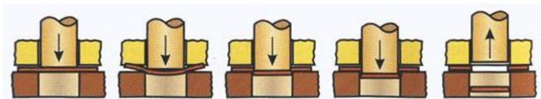
Obr.: 2 Princip stříhání pomocí stříhadla [2]
