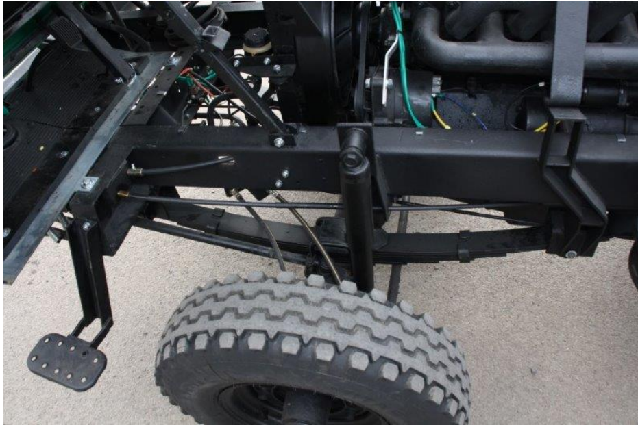
Obrázek č. 5 – umístění listové pružiny na vozidle
