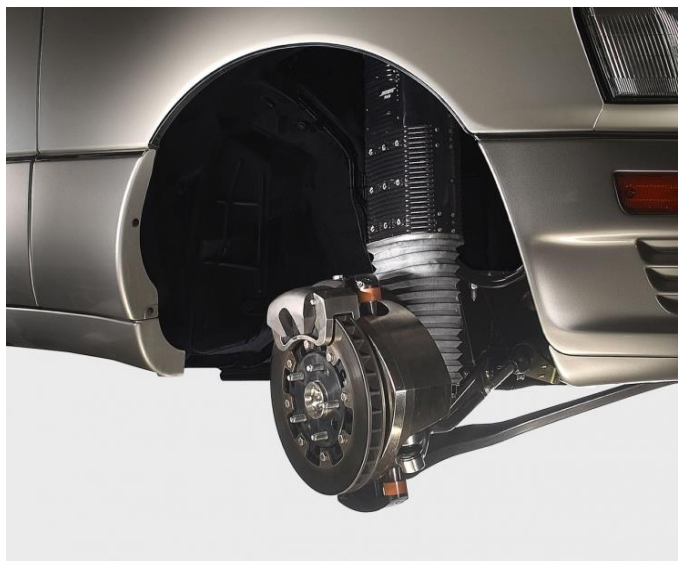
Obrázek č. 21 – tlumič systému BOSE v podběhu kola
