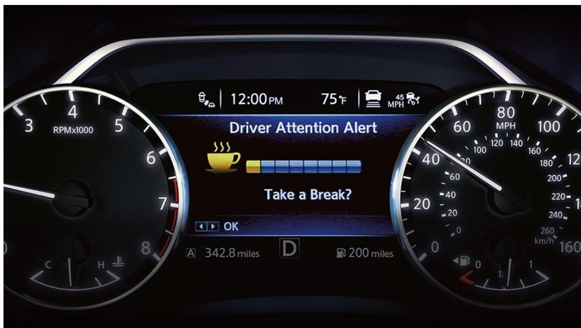
Obrázek č. 4 – Indikace ve voze značky Nissan
