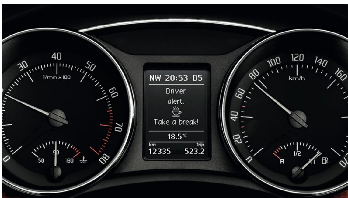
Obrázek č. 3 – Indikace ve voze Škoda Superb
