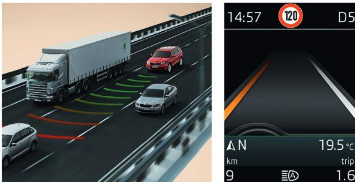
Obrázek č. 21 – Funkce systémů ACC (Adaptivní tempomat) a Lane Assist
