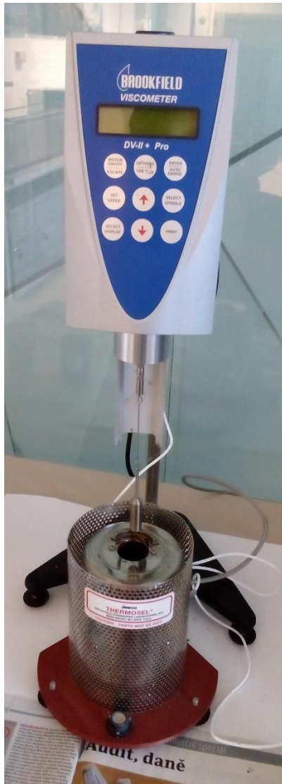
Obrázek 9. Rotační vřetenový viskozimetr a nádoby se vzorky asfaltu (foto autor).
