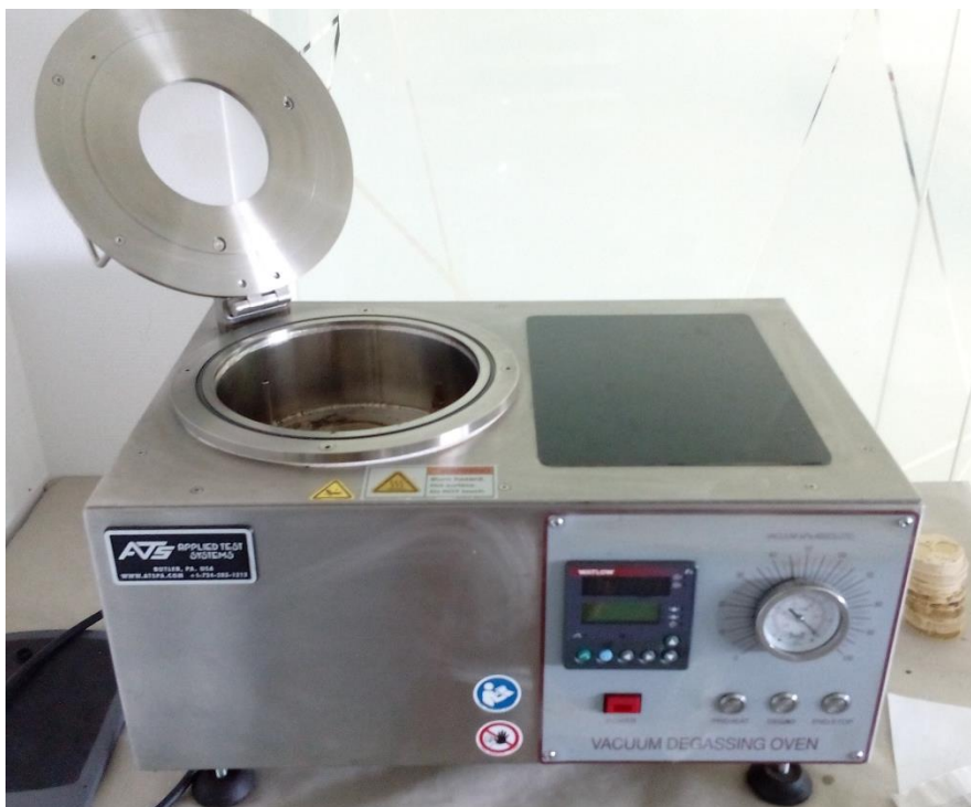
Obrázek 19. Odvzdušňovací zařízení (foto autor).
