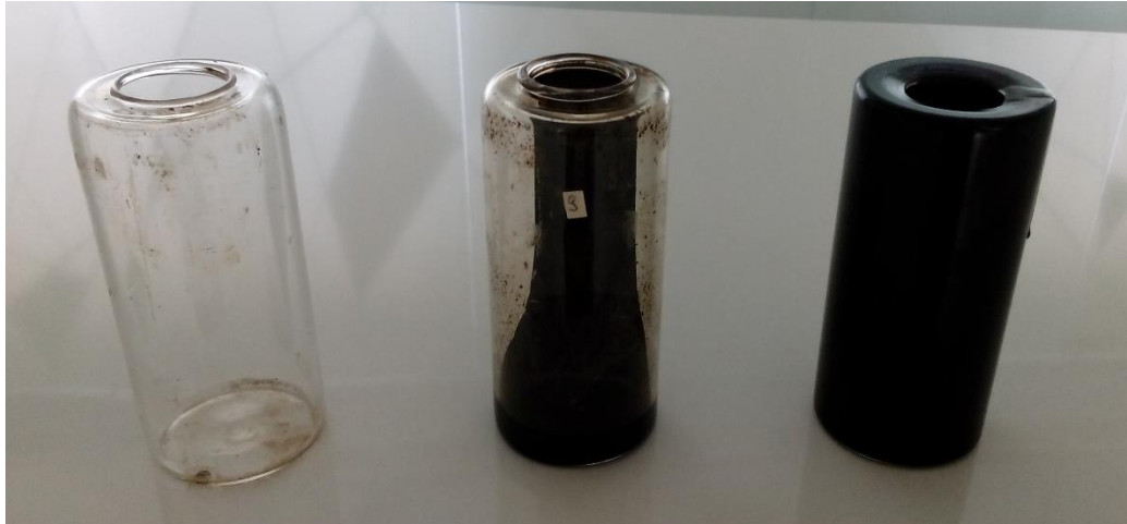
Obrázek 16. Prázdňá skleněná nádobka, nádobka s 35 gramy pojiva před zkouškou RTFOT a nádobka s 35 gramy pojiva po zkoušce RTFOT (foto autor).
