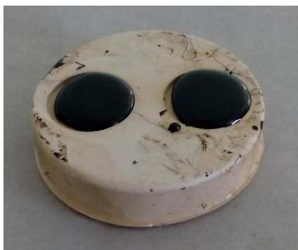
Obrázek 11. Vzorky asfaltových pojiv v silikonové formě pro zkoušku na dynamickém smykovém reometru (foto autor).
