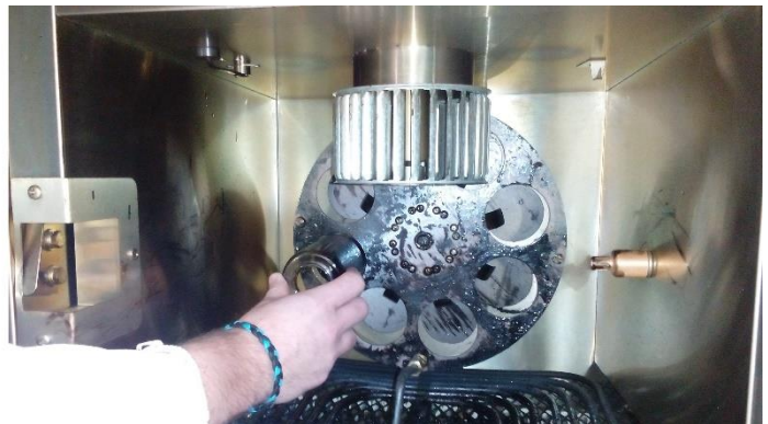
Obrázek 17. Sušárna pro zkoušku RTFOT a vkládání skleněných nádobek s asfaltovým pojivem (foto autor).
