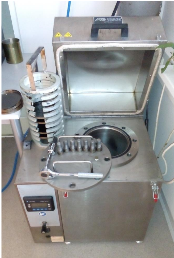
Obrázek 18. Zkušební přístroj pro dlouhodobé stárnutí PAV a misky se zestárým asfaltovým pojivem (foto autor).
