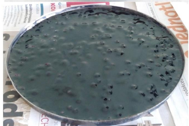
Obrázek 18. Zkušební přístroj pro dlouhodobé stárnutí PAV a misky se zestárým asfaltovým pojivem (foto autor).
