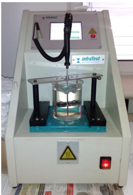
Obrázek 8. Přístroj na stanovení bodu měknutí metodou kroužek a kulička a detail propadu kuličky (foto autor).
