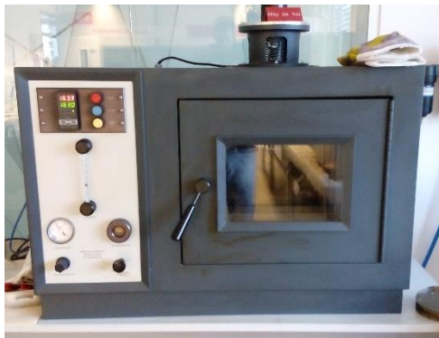
Obrázek 17. Sušárna pro zkoušku RTFOT a vkládání skleněných nádobek s asfaltovým pojivem (foto autor).
