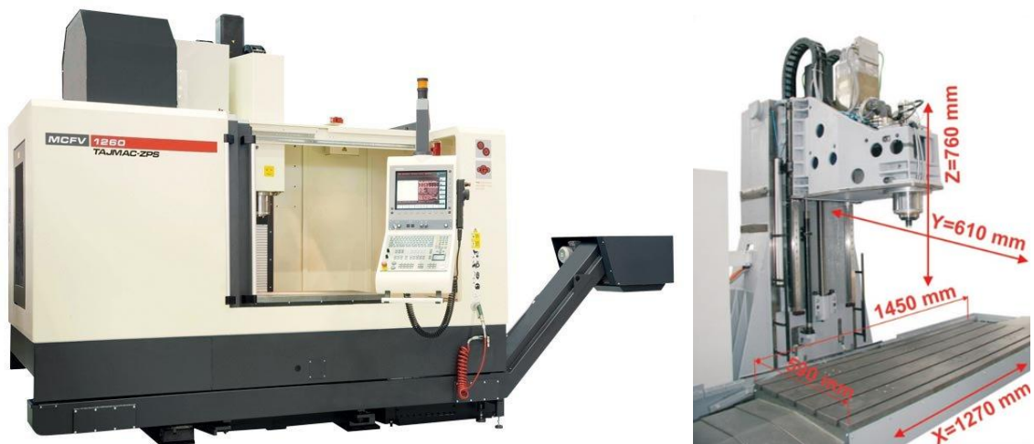
Obrázek 9 Vertikální obráběcí centrum MCFV 1260
