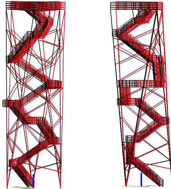
obr. 23: První a druhý vlastní tvar kmitání ( f_1 = 2,44 Hz, f_2 = 2,49 Hz)
