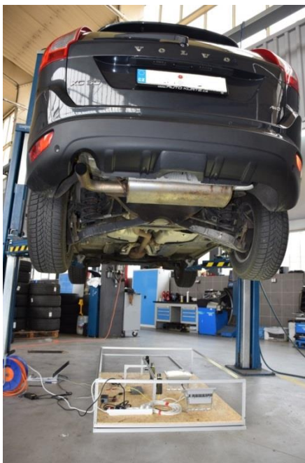
Obr. 11 Ukázka způsobu snímání podvozku automobilu pro získání experimentálních dat
