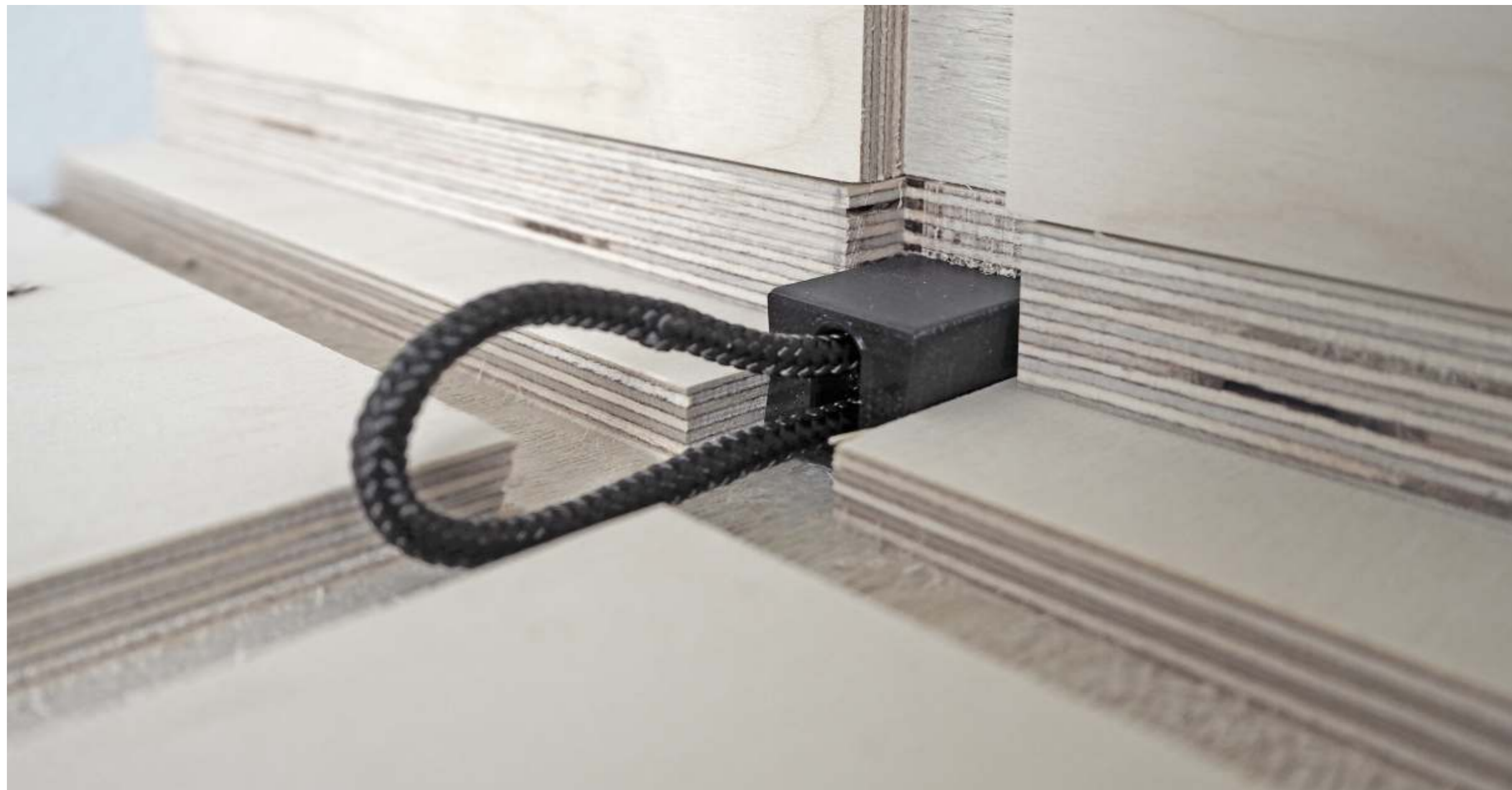
Detailní pohled na rybinové drážky s kolkem
