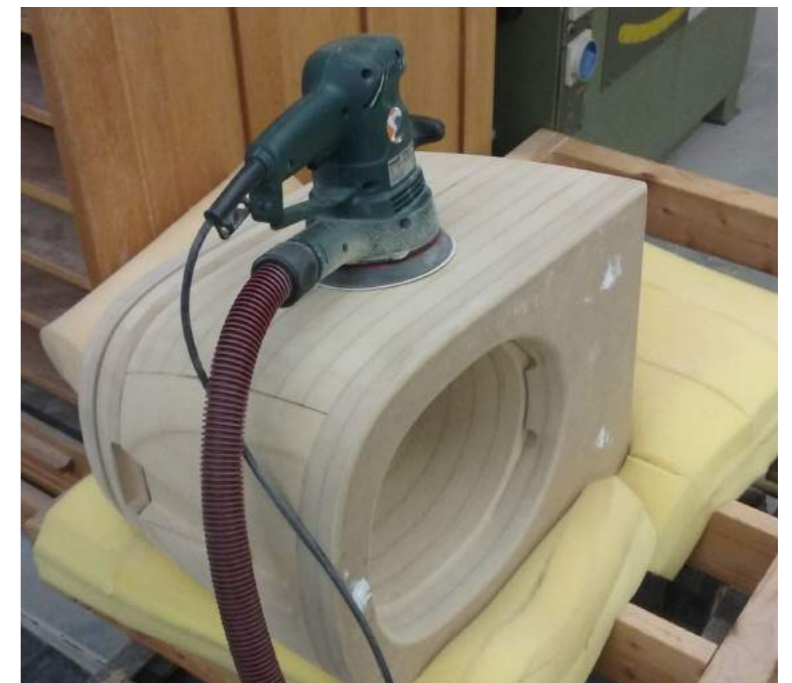
broušení do požadovaného tvaru CNC fréza nepracovala vnější plochy
