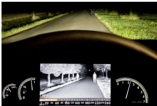
Obrázek 14 Využití IR kamery pro noční vidění v Mercedes Benz [14]
