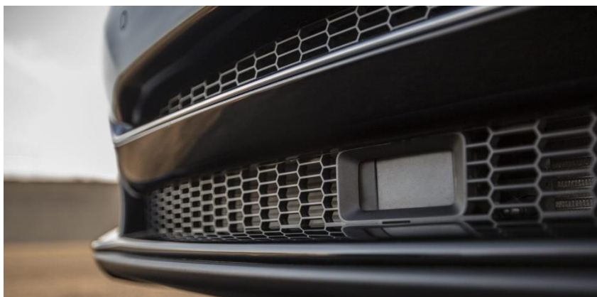
Obrázek 9 Tesla radar senzor v předním nárazníku [9]
