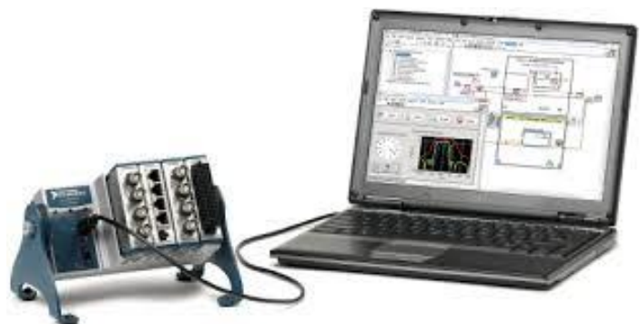
Obrázek 36 Převodníková základna s kartou a měřícím notebookem [26]
