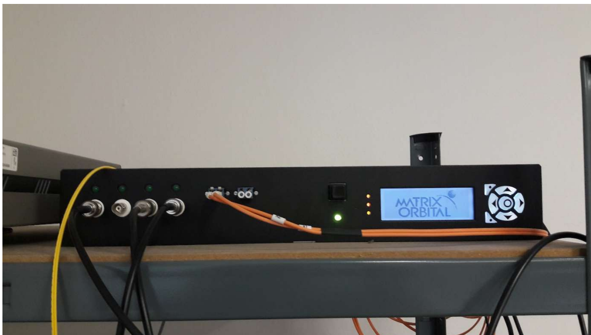
Obrázek 10.3: Adaptér pro porovnávání dvoucestnou metodou přenosu času po optických vláknech provozovaný Laboratoří přesného času a frekvence FEL ČVUT. Zapůjčeno sdružením CESNET.
