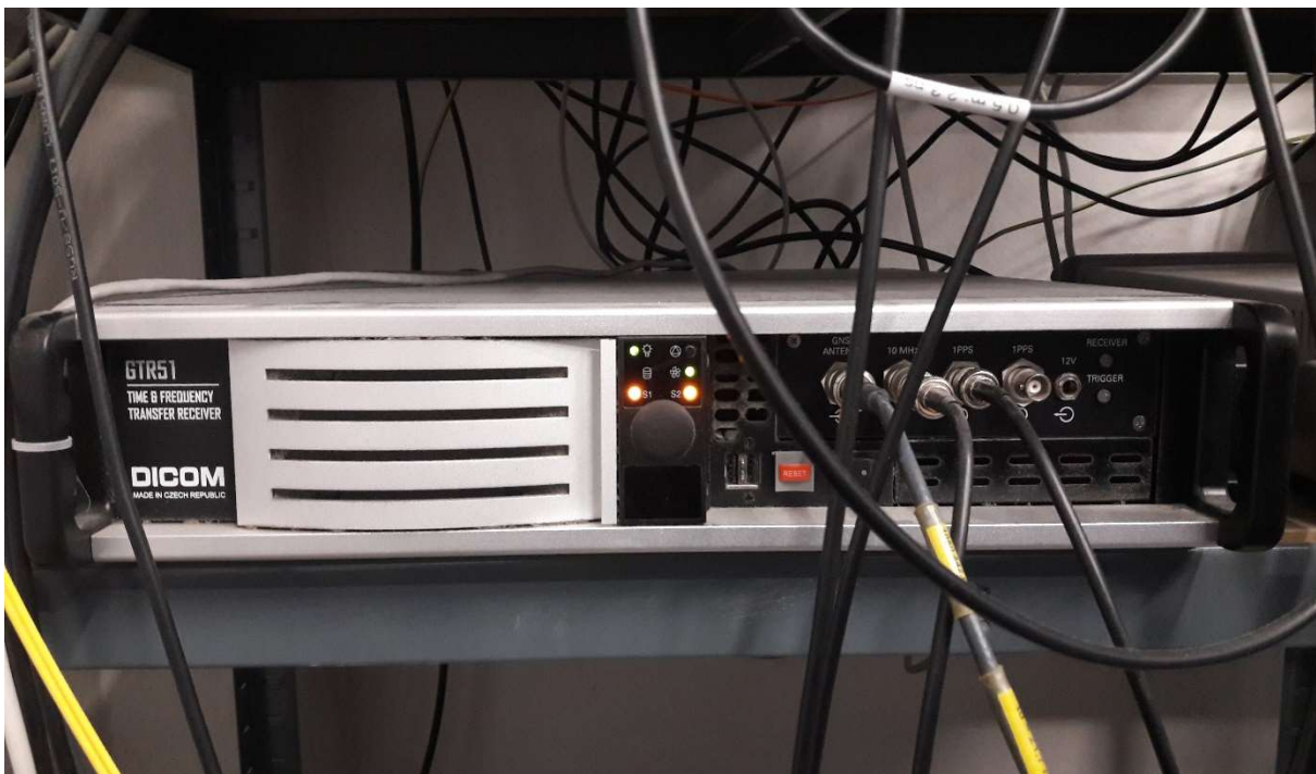
Obrázek 10.2: GNSS přijímač GTR 51 provozovaný Laboratoří přesného času a frekvence FEL ČVUT.
