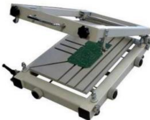
Obr. 9 nanášecí zařízení pro šablonový tisk [8]
