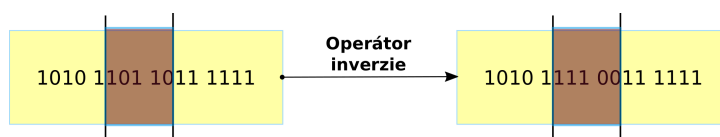
Obr. 2.2: Na obrázku je možné vidieť znázornenie fungovania inverzie u genotypu jedného jedinca. Na začiatku sa vyberie časť jedincovho genotypu. V nej sa uskutoční preusporiadanie poradia bitov. Následne takto preusporiadané bity vrátime do pôvodnej lokácie v genotype.
