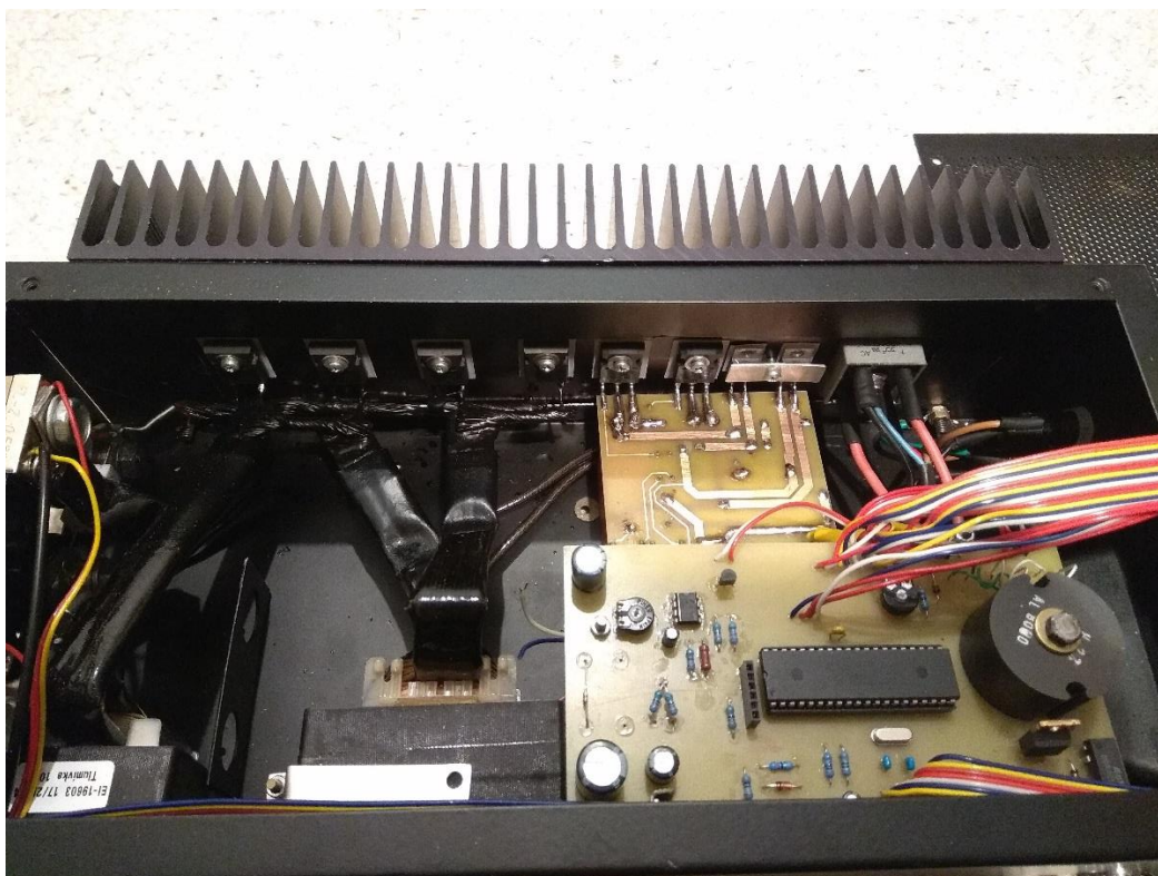
Obrázek 18 - Vnitřní uspořádání prototypu svářečské stanice
