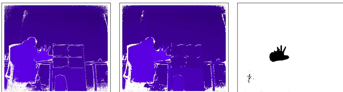
Obrázek 17 Prahování s odchylkou 15 a) originální obraz b) po filtraci c) binární obraz
