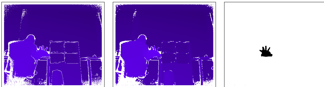
Obrázek 16 Prahování s odchylkou 12 a) originální obraz b) po filtraci c) binární obraz
