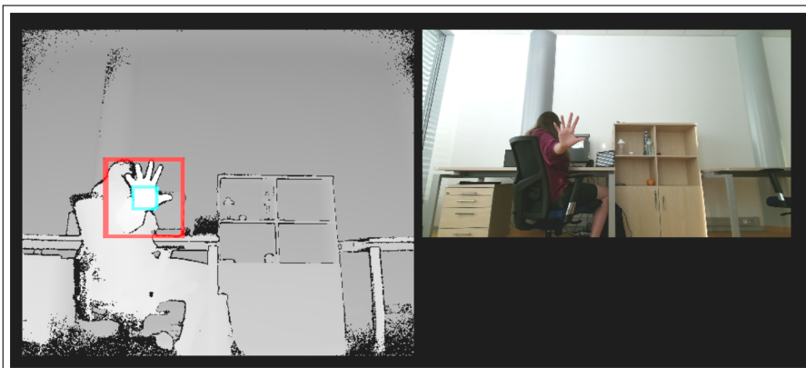
Obrázek 21 Červený čtverec znázorňuje polohu a velikost nalezeného nejbližšího objektu. Zelený čtverec obkresluje největší nalezený čtverec v objektu.
