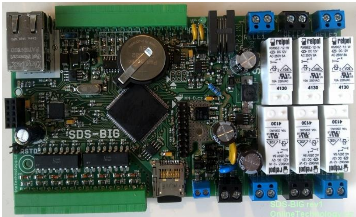
Obrázek 17: Fotografie modulu SDS-BIG bez plastové DIN krabičky, ve které je modul umístěn [34].
