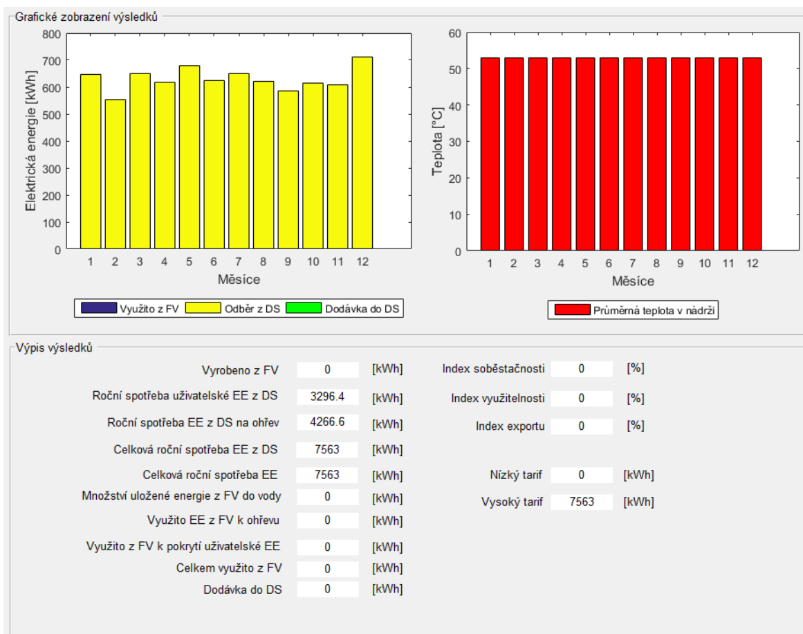
Obrázek 4-1 Výsledky simulace výchozího návrhu pro ohřev bez řízení se signálem HDO
