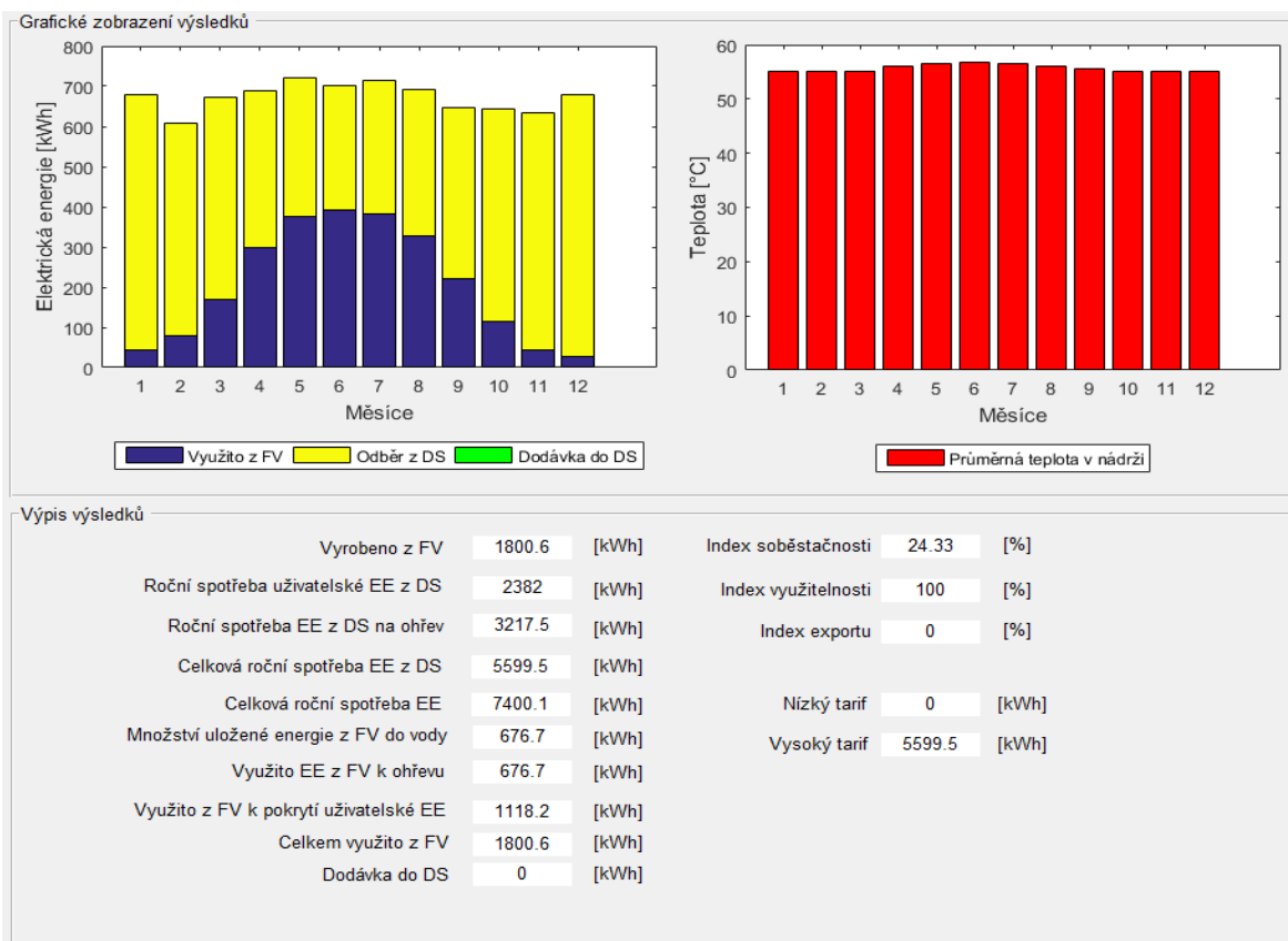
Obrázek 3-10 Výsledky simulace vlastního nástroje pro zadané parametry, bez HDO
