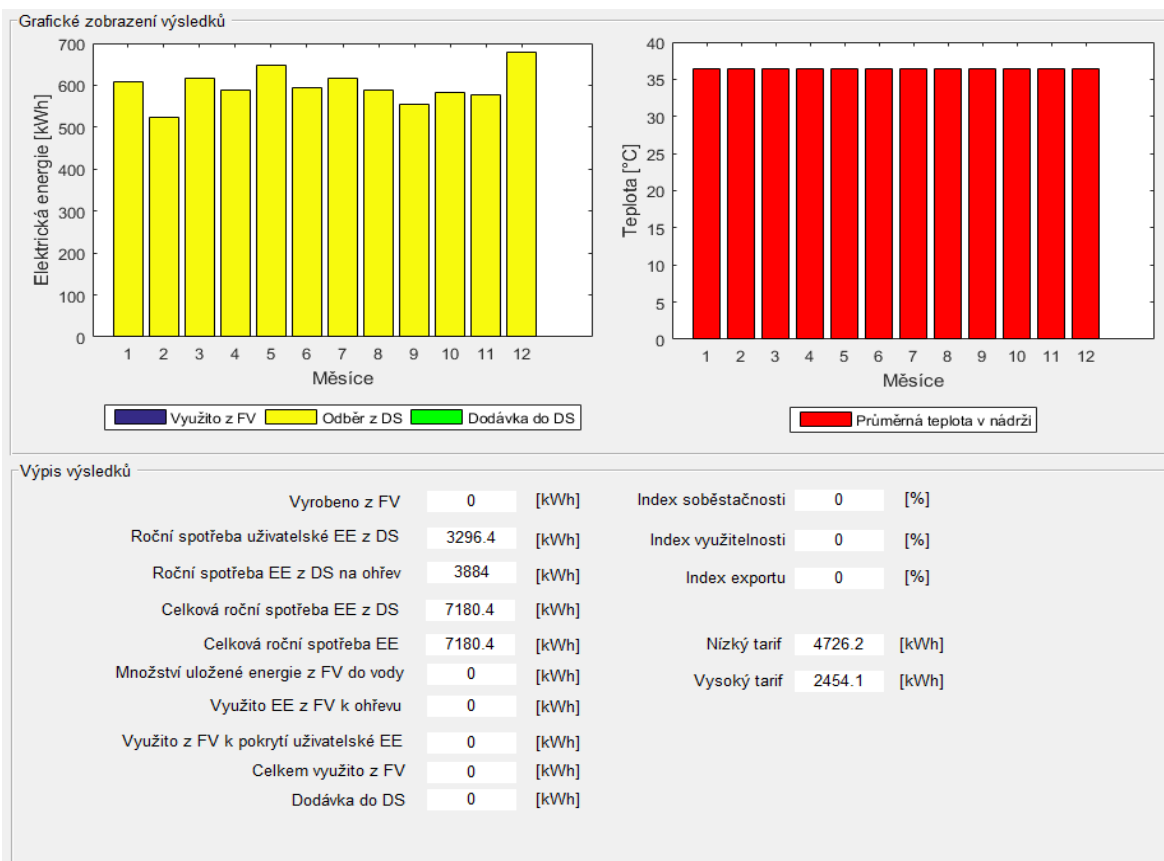
Obrázek 4-2 Výsledky simulace výchozího návrhu pro ohřev se signálem HDO
