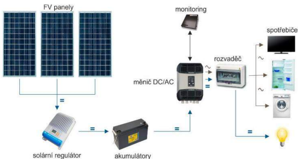
Obrázek 3.2 - Schéma ostrovního systému (off-grid) [9]
