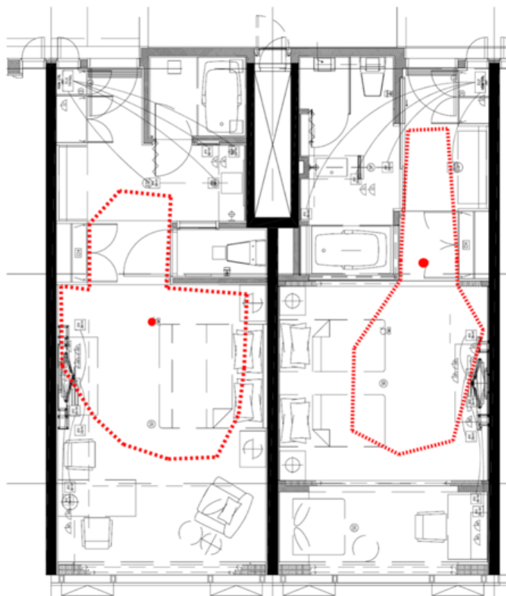
OBRÁZEK 24 NEVHODNÉ UMÍSTĚNÍ DETEKTORU
