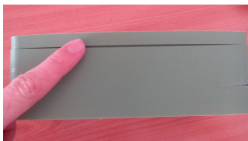
Obr. 5.12: Chyba tlače z ABS plastu
