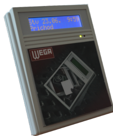
Obr. 1.1: Bezkontaktný terminal firmy WEGA LH
