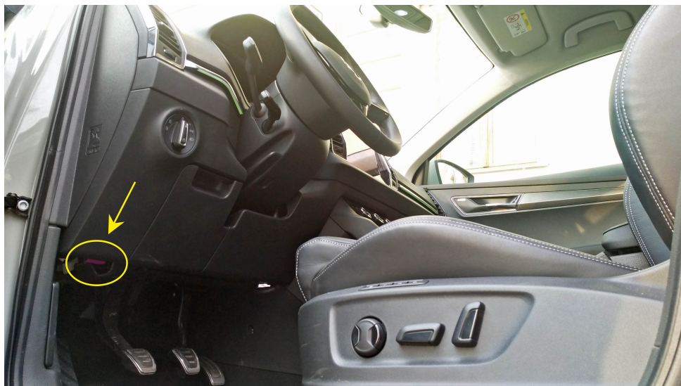
Obrázek 1.4: Pozice OBD-II konektoru ve vozidle Škoda Karoq 2018
