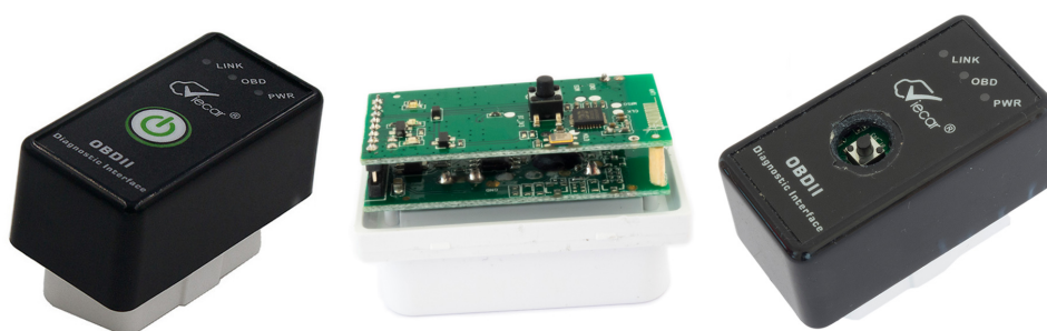
Obrázek 4.8: Adaptér Viecar – vlevo originální, uprostřed bez obalu, vpravo s vyvrtanou dírou na tlačítko
