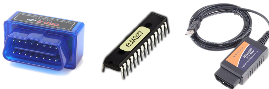
Obrázek 3.4: Uprostřed mikročip ELM327 a po stranách na něm založené adaptéry ELM327
