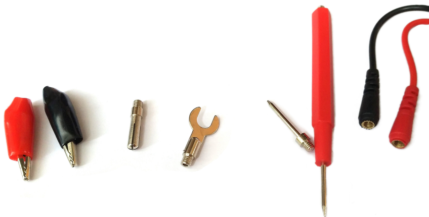
Obrázek 4.6: Měřící šňůry (vpravo) a k nim koncovky – zprava jehly, oko, banánek a krokosvorky
