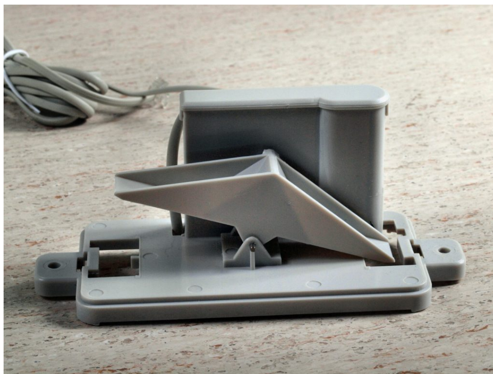
Obrázek 2.1: Rozebraný srážkoměr, zdroj obrázku: [5]
