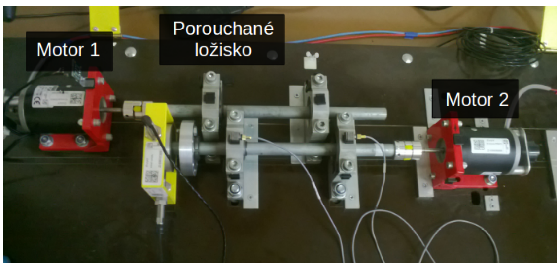
Obrázek 7.1: Simulátor vibrací použitý při ověření funkčnosti monitorovacího zařízení.
