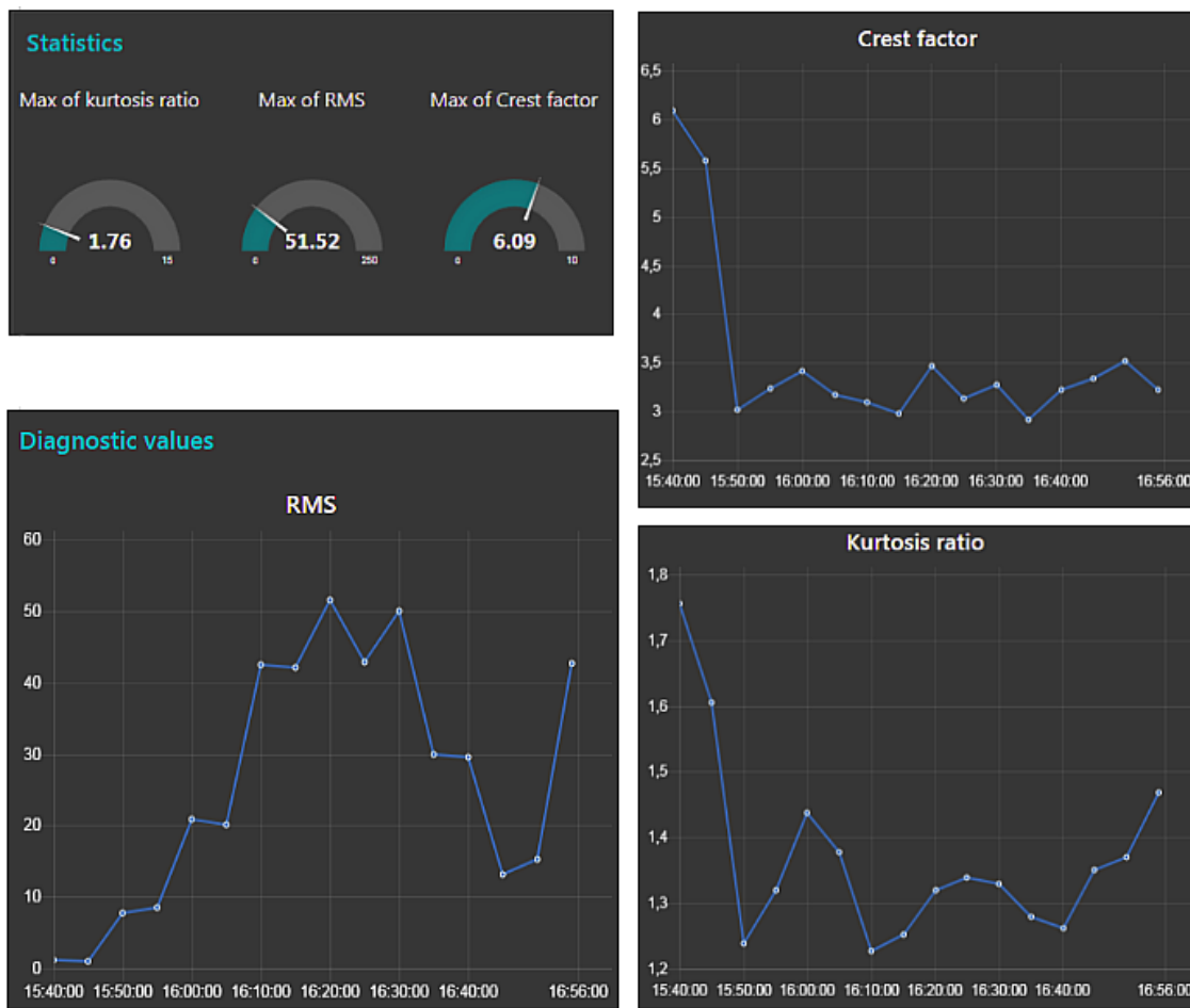
Obrázek 7.5: Časový průběh RMS, crest factoru a kurtosis ratio a jejich maximální hodnoty za dobu měření zobrazované pomocí měřidel.
