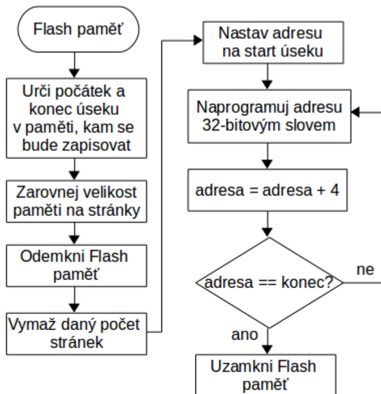
Obrázek 6.5: Schéma zápisu do Flash paměti po 32 bitových slovech.
