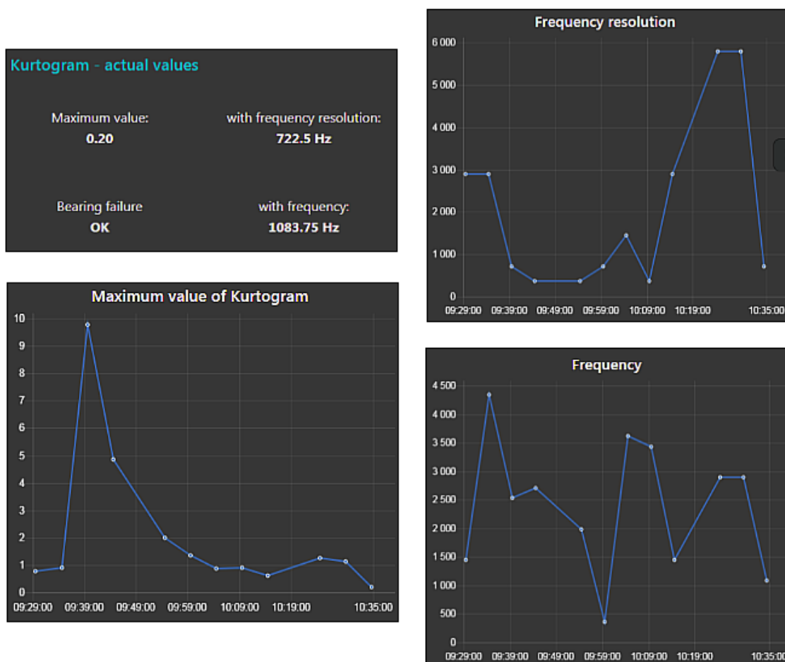
Obrázek 7.21: Poslední údaje o nalezeném maximu a průběh maximální hodnoty kurtogramu, frekvence, kde byla nalezena a příslušné šířce pásma v čase.
