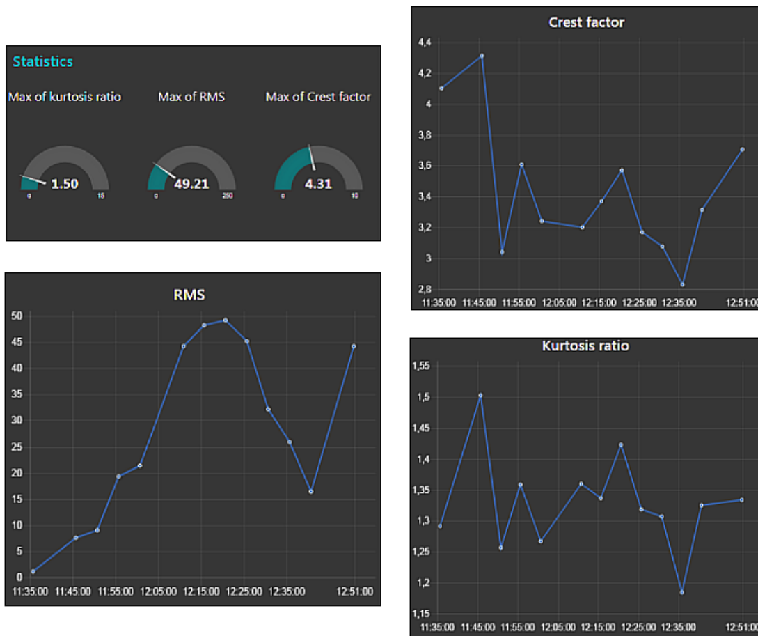
Obrázek 7.15: Časový průběh RMS, crest factoru a kurtosis ratio a jejich maximální hodnoty za dobu měření zobrazované pomocí měřidel.
