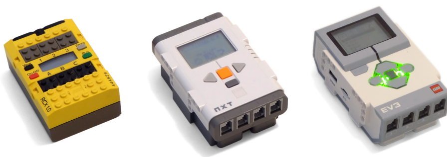
Obrázek 2.2: Inteligentní kostky Mindstorms: RCX (vlevo), NXT (uprostřed), EV3 (vpravo) [2]
