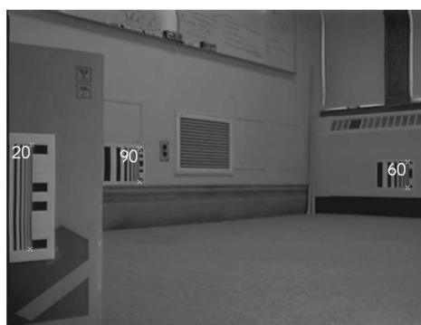
(a) Přirozené orientační body v místnosti [6] (b) Čárový kód jako orientační bod [19]
