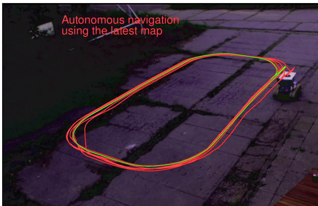
Obrázek 29: Měření přesnosti navigace pomocí externího lokalizačního systému [11]
