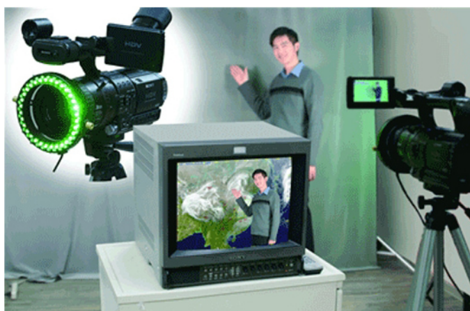
Obrázek 11: Ukázka principu klíčování pomocí Reflecmedia systému [11].
