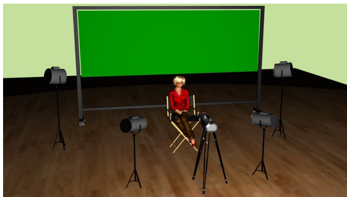
Obrázek 13: Ukázka odděleného nasvícení Backdropu [5].
