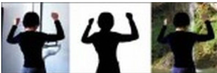
Obrázek 7: Ukázka principu rozdílového klíčování: na obrázku vlevo je obraz popředí, na obrázku vpravo je popředí s požadovaným pozadím, uprostřed spočítaná maska [4].
