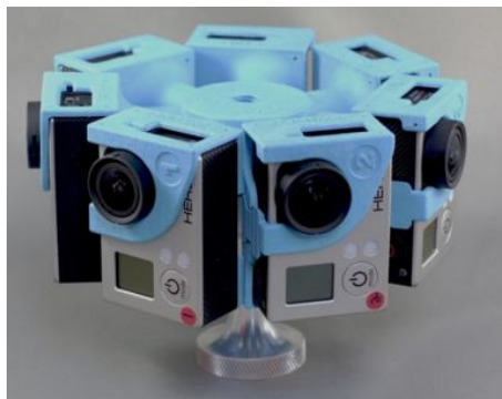
Obrázek 3.18. Kamerový set H3PRO – 7HD firmy GoPro pro 360-stupňové video. Převezato z [23].
