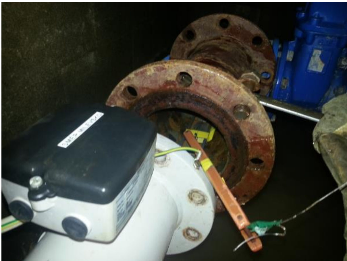
Obr. 13 Vyjmutí kuponů po dané době expozice
