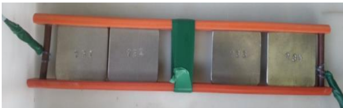
Obr. 11 Čtyři zkušební kupony upevněné v držáku a připravené pro vložení do potrubí
