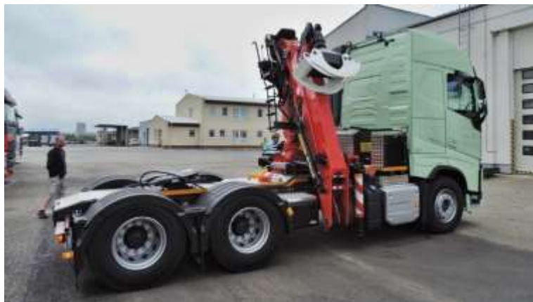
Obrázek 12: Automobilová nástavba s návěsovou točnicí [16]
