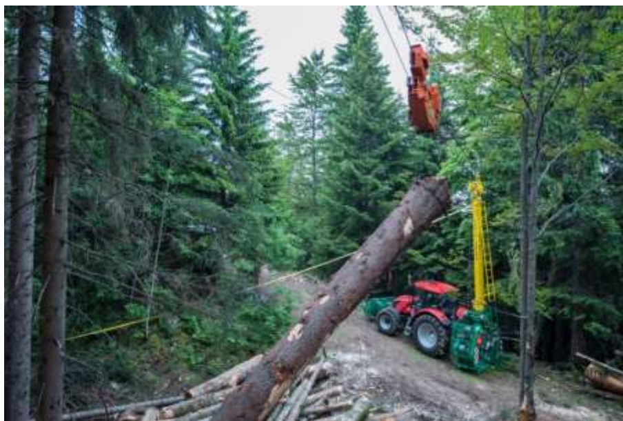
Obrázek 8: Soustředování dříví pomocí lanovky [14]
