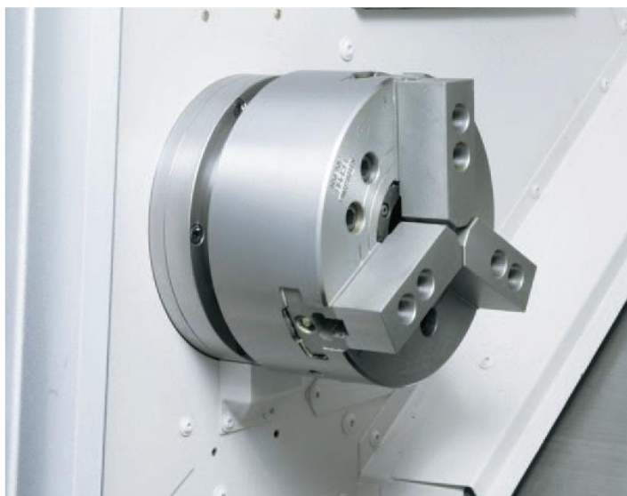
Obr. 7: Sklíčidlo hlavního vřetene [převzato z 5]
