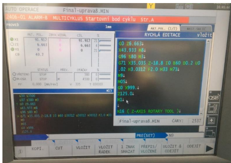
Obr. 22: 3. chybová hláška – oprava
