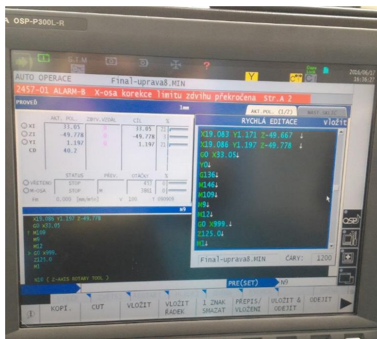
Obr. 18: 1. chybová hláška – oprava
