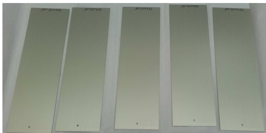
Obr. č.21: Vzorky z mat. 2024 po eloxu v kyselině sírové
