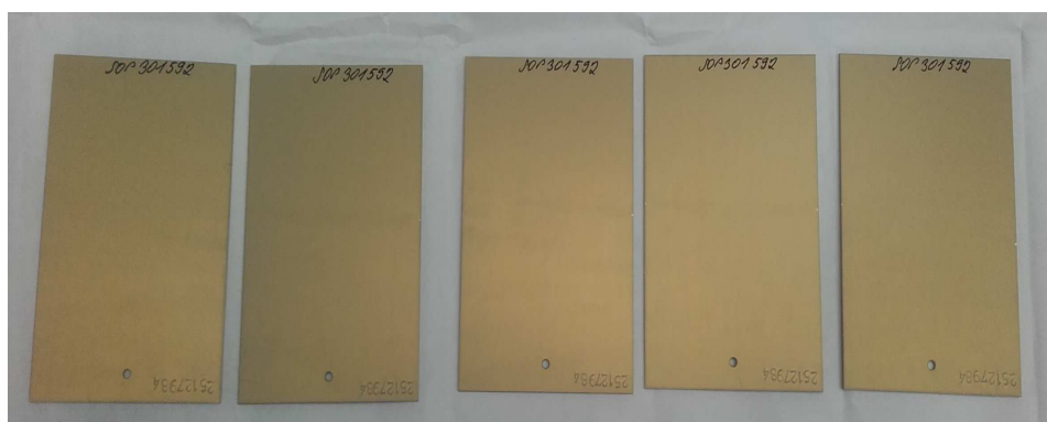
Obr. č.22: Vzorky z mat. 7075 po eloxu v kyselině sírové
