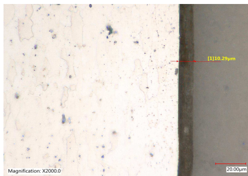
Obr. č.61: Tloušťka eloxu mat.7075
