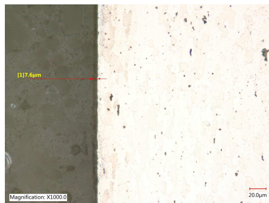
Obr. č.45: Tloušťka eloxu mat.7075
