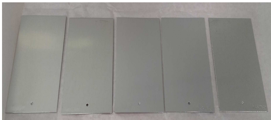
Obr. č.30: Vzorky z mat. 7075 po eloxu v kyselině vinné
