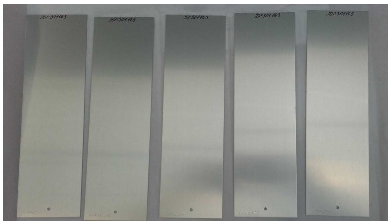
Obr. č.25: Vzorky z mat. 2024 po eloxu v kyselině borité
