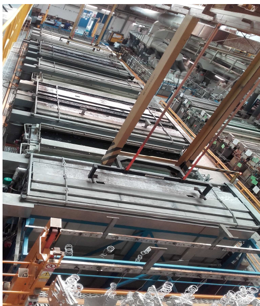
Obr. č.5: Automatická anodizační linka
