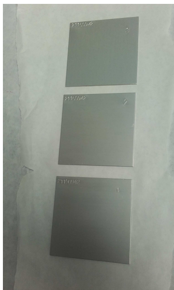
Obr. č.33: Vzorky po eloxu v kyselině vinné
