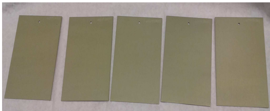
Obr. č.18: Vzorky z mat. 7075 po eloxu v kyselině chromové
