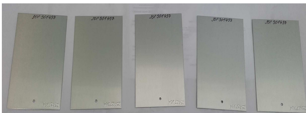
Obr. č.26: Vzorky z mat. 7075 po eloxu v kyselině borité
