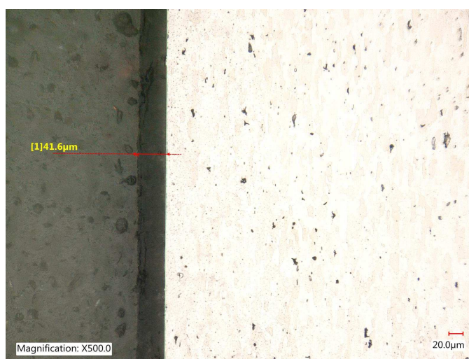
Obr. č.49: Tloušťka eloxu mat.7075
