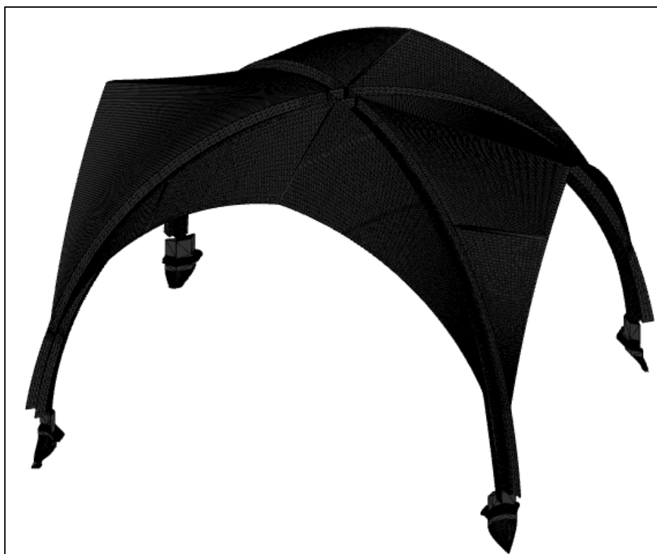
Obr. 26 3D plný drátový model“ Klenby s konzolami“ vytvořený v MicroStationu V8i pomocí 2D archu
