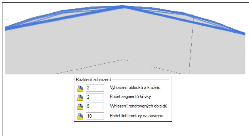
Obr. 17 Nízké rozlišení zobrazení 3D modelu Okna (šipka uvádí izočáry plochy)
