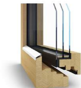
DŘEVĚNÁ OKNA JÁNOŠÍK, typ RAND 2.0 Integrace křídla za rám
