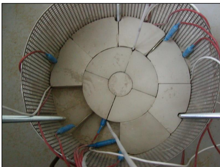
Obr. 8 – Prefabrikované tvárnice z bentonitu jako buffer (Vašíček a kol.)
