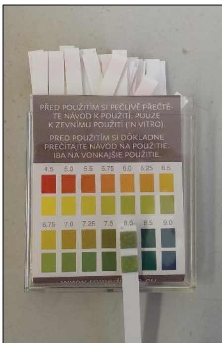
Obr. 14 – Indikátorové papírky a barevná stupnice pH
