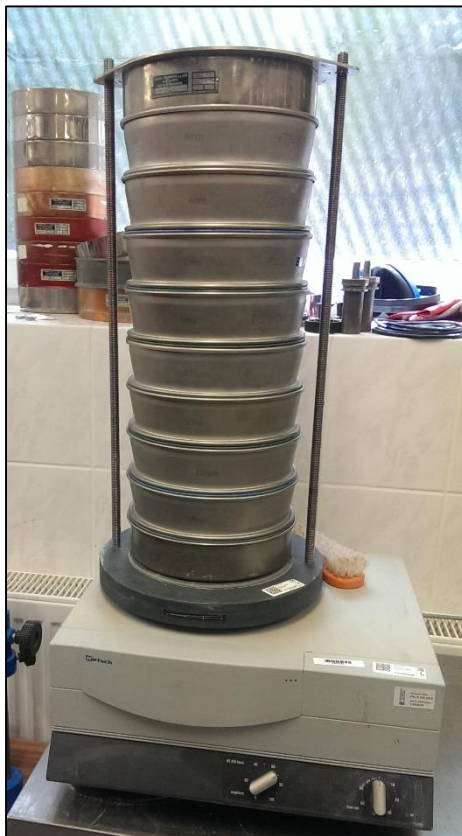
Obr. 15 – Prosévací zařízení s vibrační deskou
