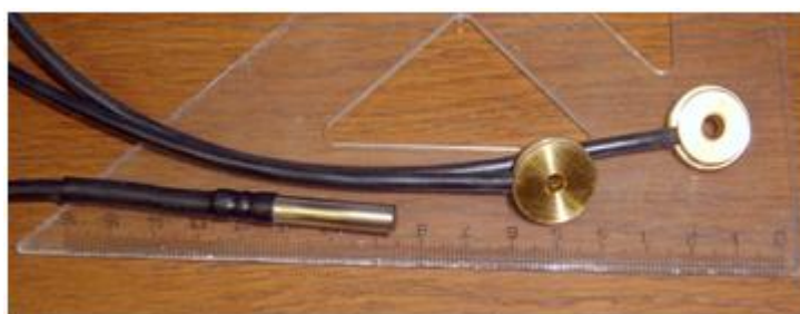
Obr. 3.7 Pohled na teplotní sondy N1ATG8 (vlevo) a N1ATG7 (vpravo)
