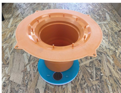
Obrázek č. 5, Váhové měření jednotlivých prvků odvodnění střech
