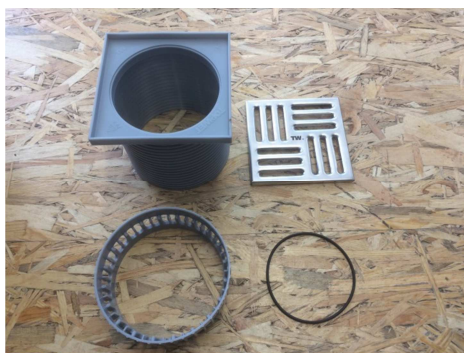
Obrázek č. 4, Váhové měření jednotlivých prvků odvodnění střech
