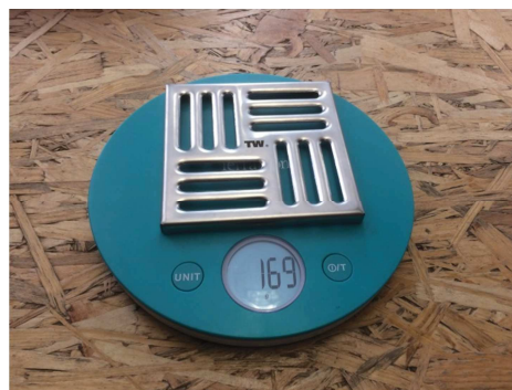
Obrázek č. 4, Váhové měření jednotlivých prvků odvodnění střech
