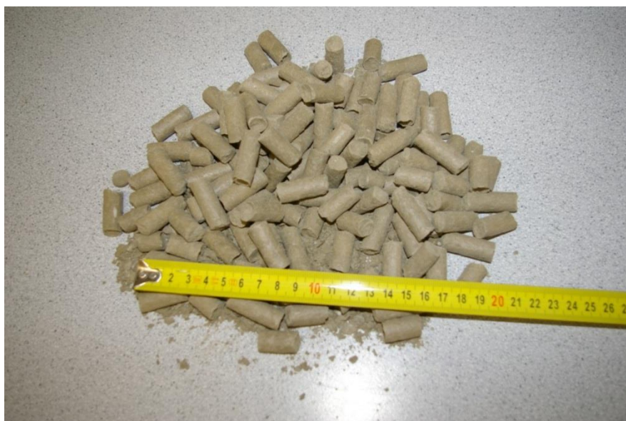
Obr. 31 – Fotografie vylisovaných bentonitových pelet o průměru 12 mm z ČLUZ a.s.
