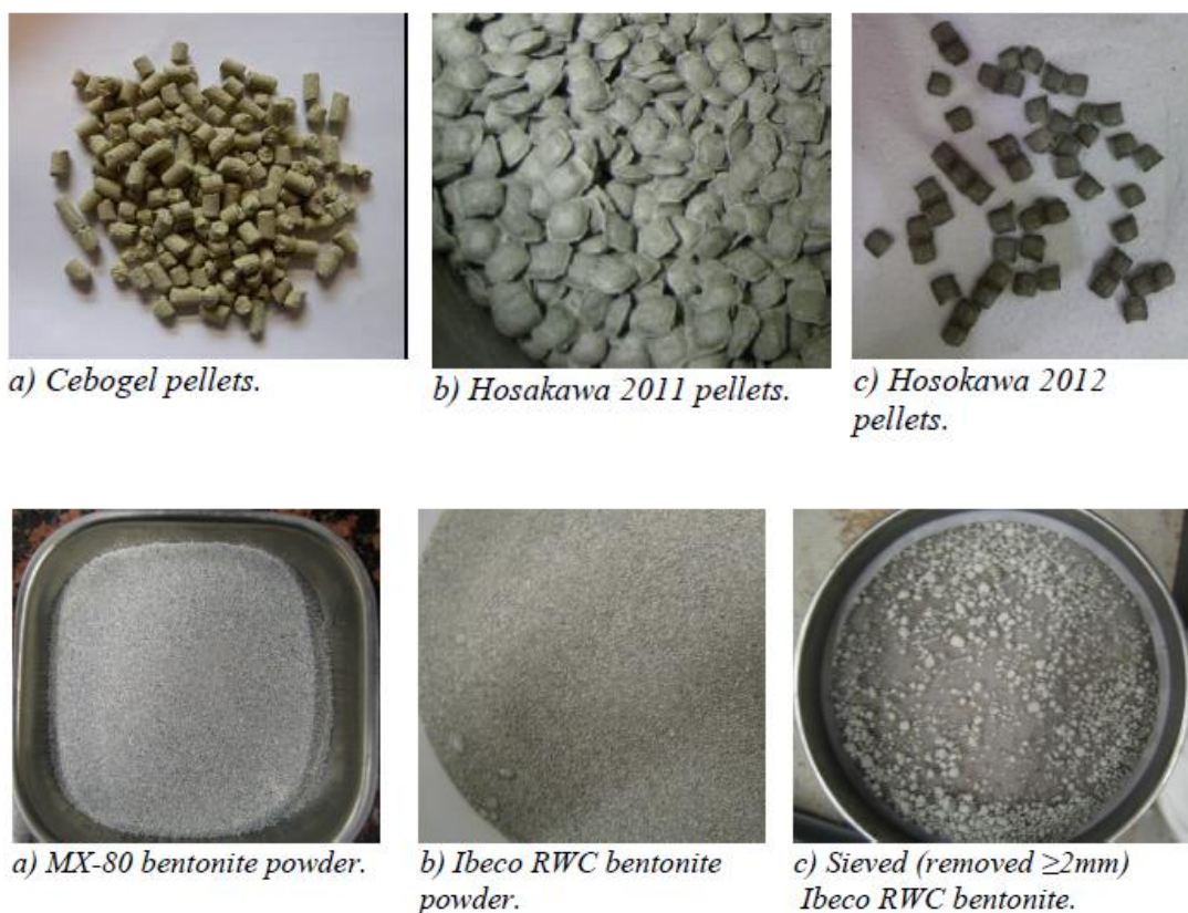
Obr. 12 – Finské pelety (nahore) a drtě (dole) zkoušené v práci [16].
