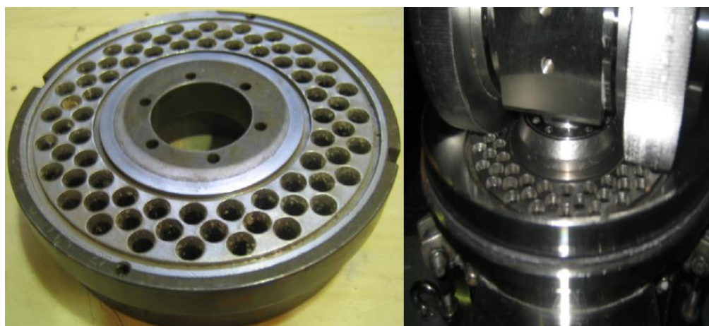
Obr. 29 – Vlevo matrice pro ztuhování pelet a vpravo detail umístění matrice ve stroji. Na obrázku vpravo jsou zřejmé dva válce (ocelová kola s vroubkou), které se horizontálně otáčejí po matrici (vertikální osa otáčení je ve středu matrice) a zároveň se otáčejí vertikálně (horizontální osa je ve středu válců zhruba 30 cm nad matricí). Válce (kola) svými otáčivými pohyby zatlačují bentonit do kruhových otvorů v matrici [8].
