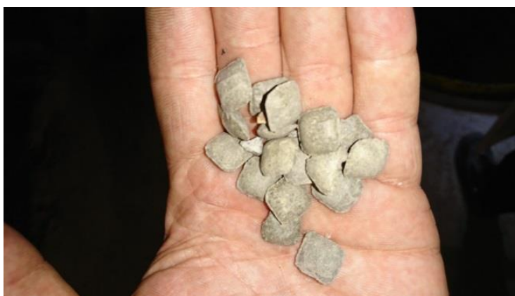
Obr. 8 – Foto bentonitových pelet (briketek) vyrobených lisováním mezi válci s perforací (foto autor).
