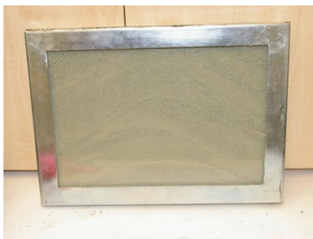
Obr. 49 – Obrázek malého ocelového modelu spáry.
