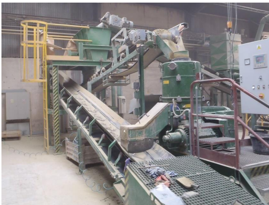
Obr. 28 – Výrobní linka pro lisování pelet. Na obrázku jsou zřejmé dva pásové dopravníky. Horní pásový dopravník sype zvlhčený materiál do stroje, ve kterém se ztuhnou pelety protlačováním skrz matrici. Bentonitové pelety ze stroje samovolně vypadávají na spodní pásový dopravník, který dopravuje pelety k expedičnímu místu.
