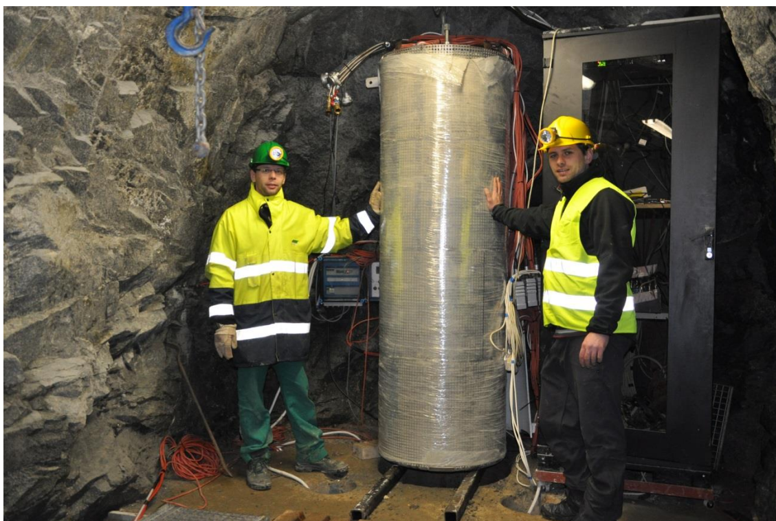
Obr. 24 – Experiment MCJ před spuštěním do velkoprofilového vrtu v Podzemní laboratoři Josef.
