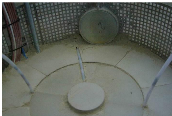
Obr. 67 - Svislé řetězové teploměry a vodorovný teploměr 128 v průběhu výstavby modelu (v ochranných plastových trubičkách jsou patrná jednotlivá čidla).
