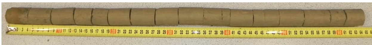
Obr. 89 – Jádra ze třetího odvrtu
