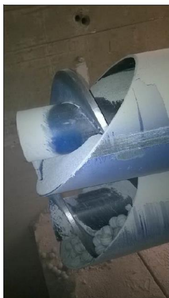
Obr. 18 – Obrázky z výstavby bentonitové vrstvy z pelet v FSS experimentu [34].
