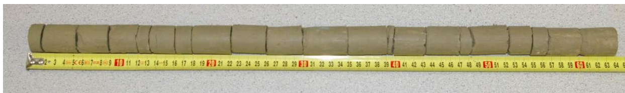
Obr. 87 – Jádra z druhého odvrtu
