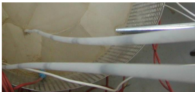
Obr. 66 - Svislé řetězové teploměry (v ochranných plastových trubičkách jsou patrná jednotlivá čidla).
