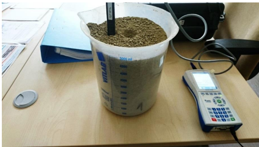
Obr. 48 – Válec 5 dm 3 pro zkoušení možností zhutnění zkoušených materiálů a pro stanovení termofyzikálních vlastností; foto je z měření a vpravo na obrázku je přístroj Isomet 2114.
