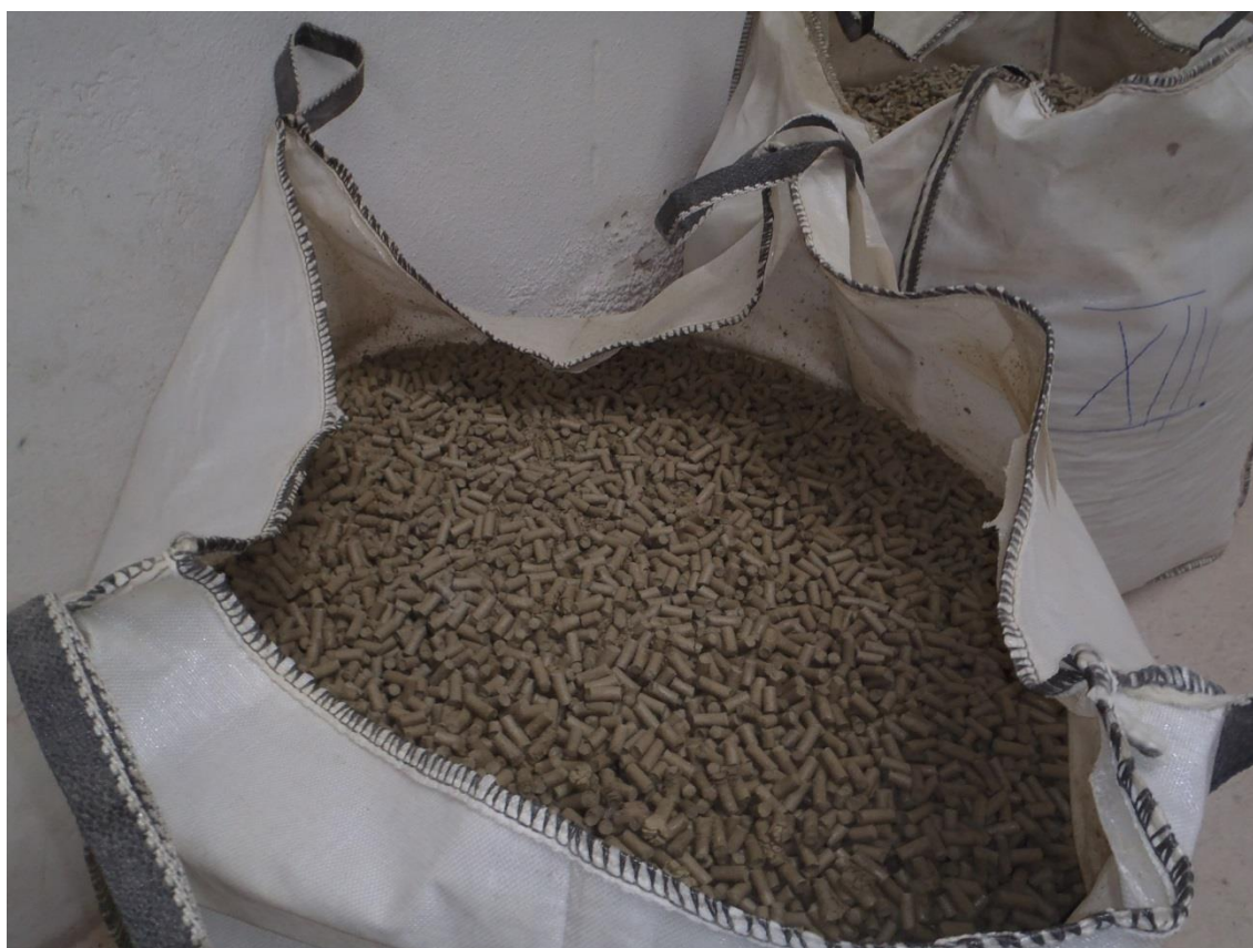
Obr. 33 – Bentonitové pelety o průměru 12 mm (B75 PEL 12) po plno provozní zkoušce lisování v ČLUZ a.s.
