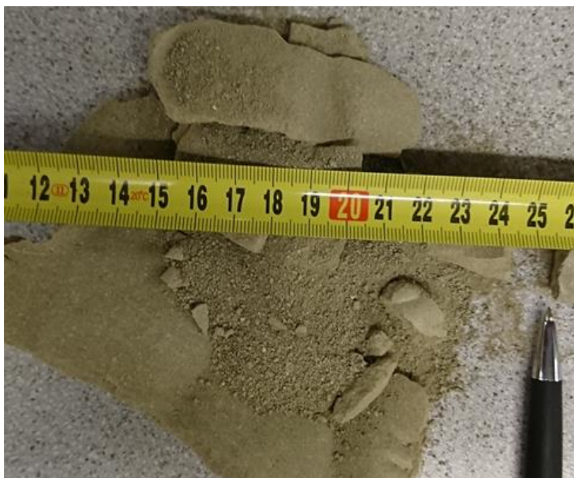
Obr. 38 – Tzv. recyklát REC z B75 – lisovaný bentonit mezi válci, na obrázku jsou zřejmé destičky o hraně v řádech cm.
