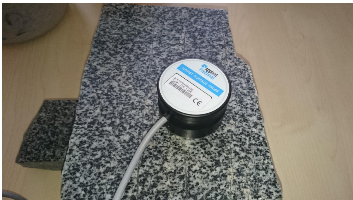
Obr. 75 – Obrázek z měření tepelné vodivosti tonalitu pro výpočty provedené v této práci
