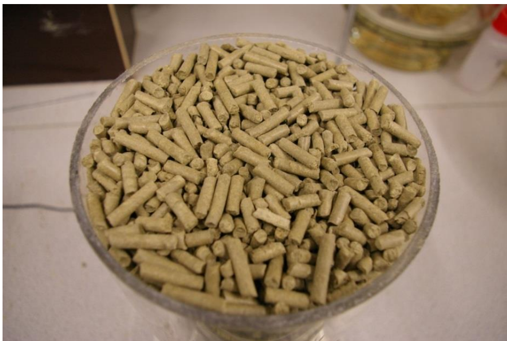
Obr. 30 – Vylisované bentonitové pelety o průměru 8 mm z ČLUZ a.s.
