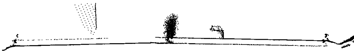
Obr. 10 Chyba v georeferencování mračen - příčný řez mračnem, 8. km (rozdíl ve výšce 0,6m)
