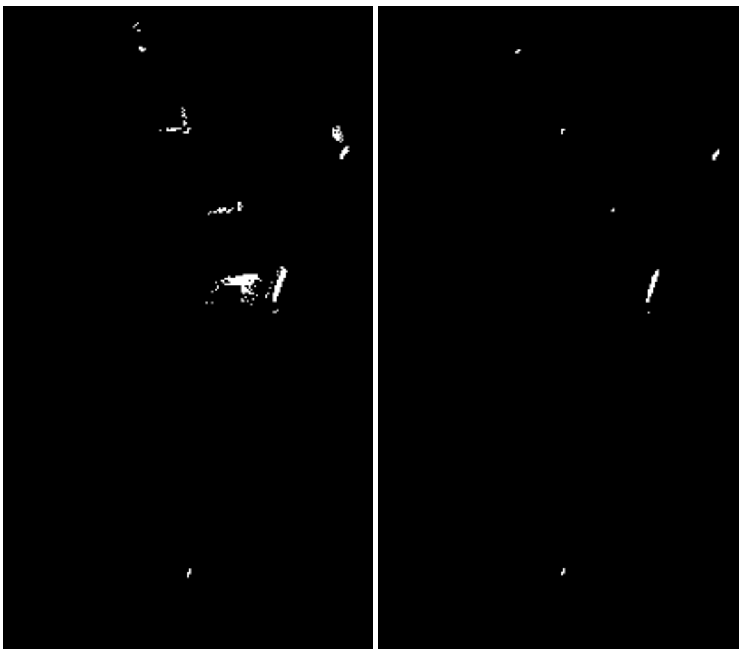
Obr. 39 Signs - primární obraz (vlevo), po aplikaci podmínky minimálního počtu bodů na pixel (vpravo); 62. km
