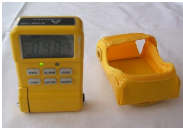
Obr.21 - Zásahová dozimetr Ultra-Rád 115[vlastní]
