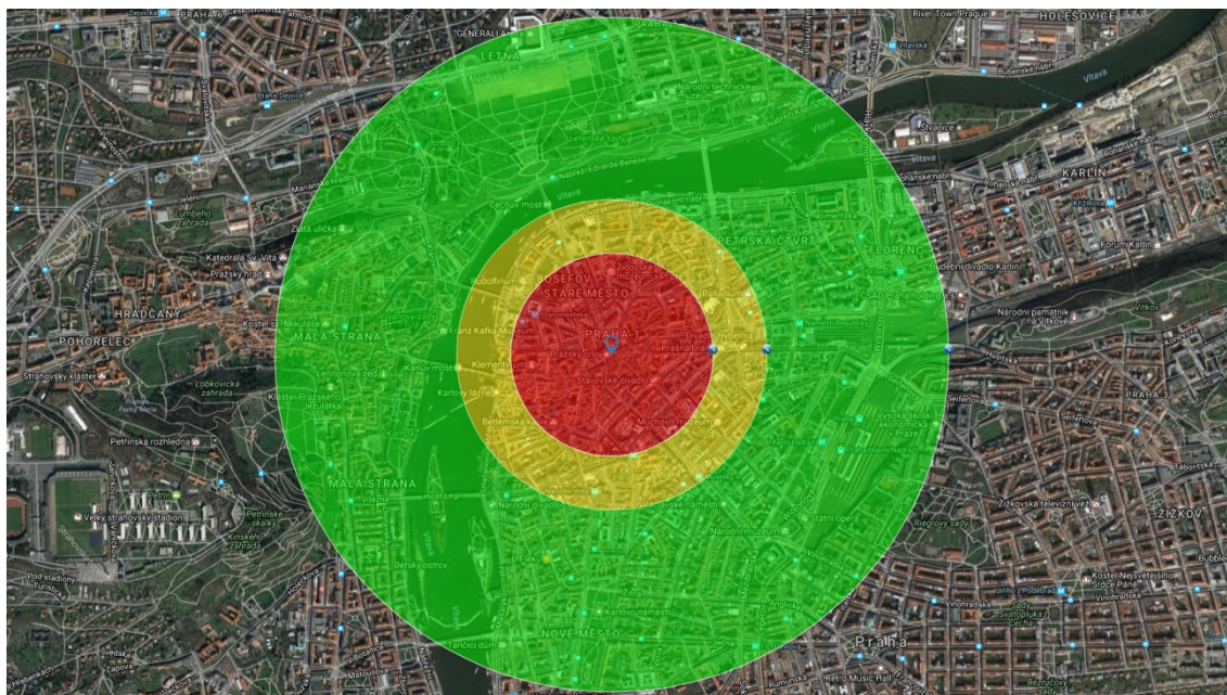
Obrázek 24 - Mapa ohrožení osob toxickou látkou Sarin – rozptyl z výšky 10 m
