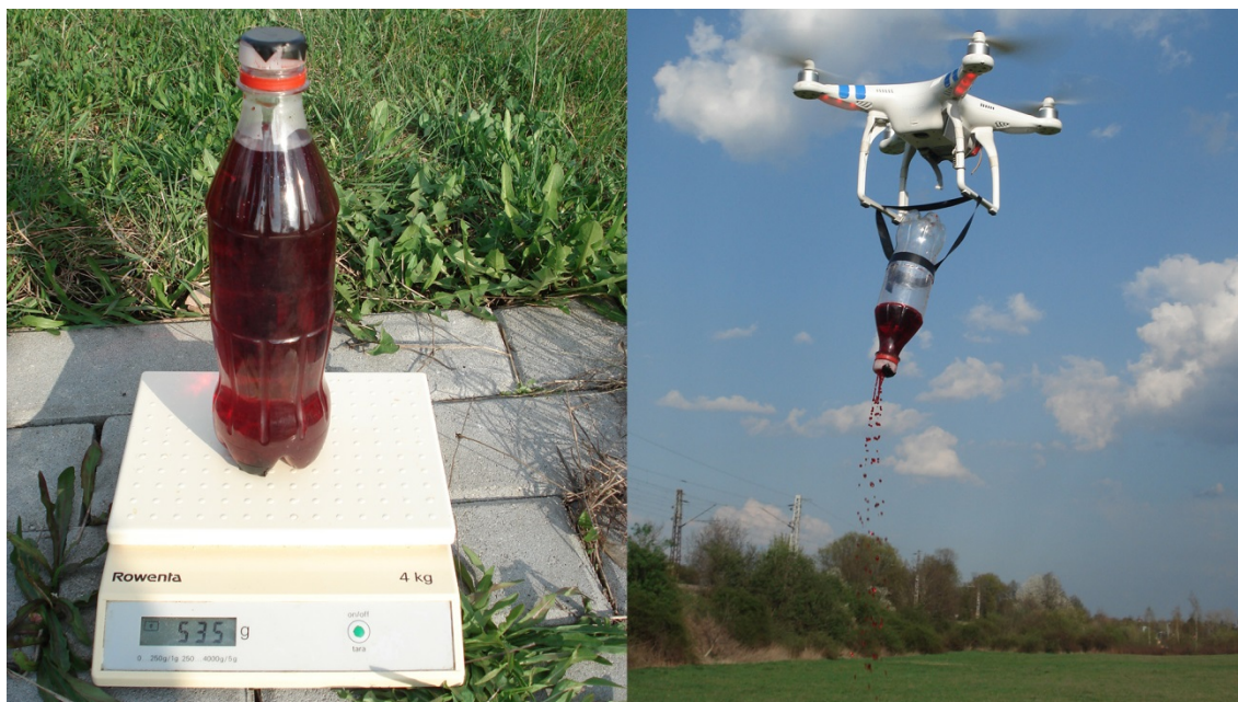
Obrázek 22 - Rozptyl kapalné látky z dronu
