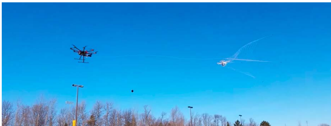
Obrázek 9 - Chytání dronu do sítě ze zařízení umístěného pod dronem [64]
