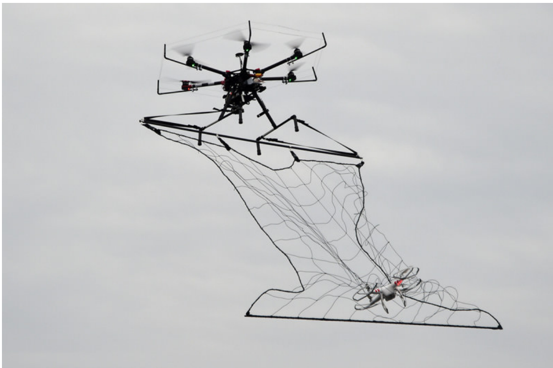
Obrázek 8 - Policejní dron se zavěšenou sítí [61]
