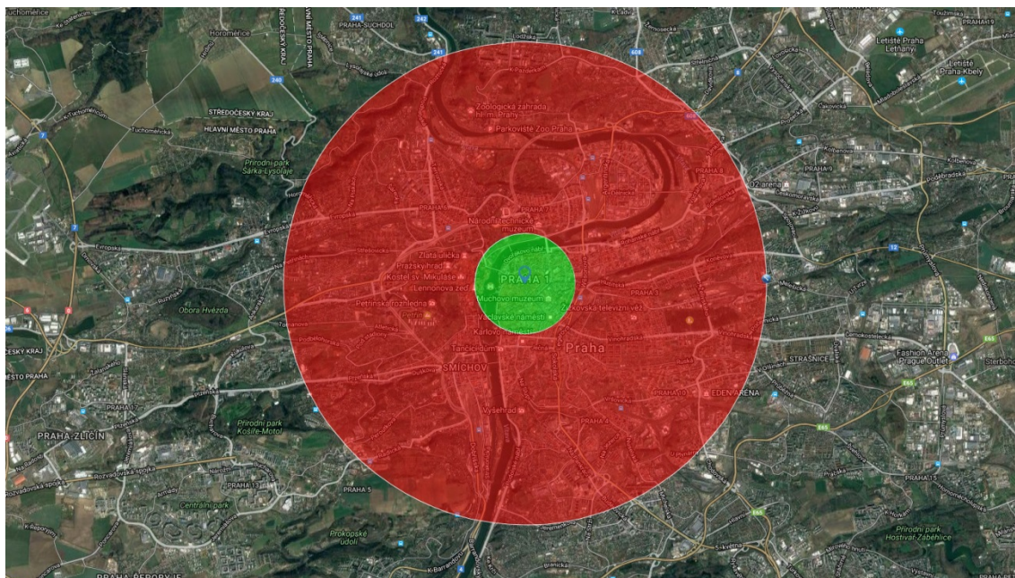
Obrázek 16 - Dosah vysílače a maximální dolet kvadrokoptéry se zátěží 650 g
