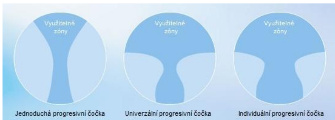
Obr. 13 – ukázka šíře využitelné optické zóny progresivní čočky(13)
