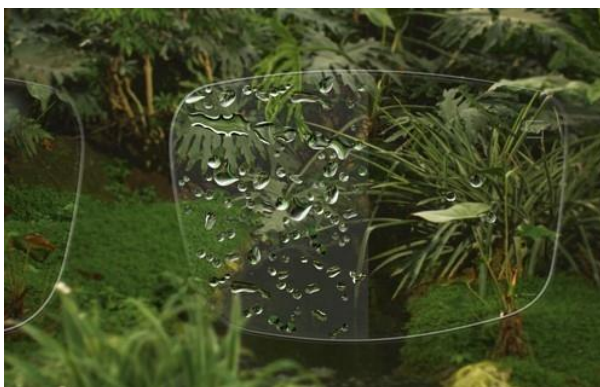
Obr. 19 – brýlová čočka bez (vlevo) a s hydrofobní vrstvou (vpravo) (19)
