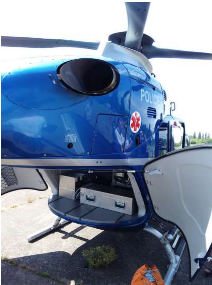
Obrázek 2 - Montáž zařízení IRIS do vrtulníku policie ČR - vlastní zdroj
