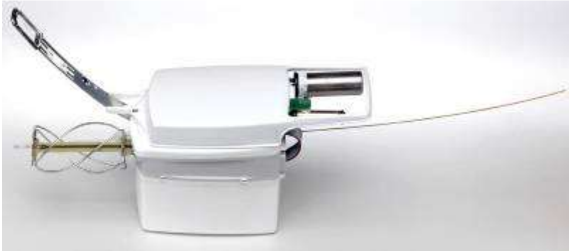
Obrázek 4 - Radiosonda VAISALA doplněná čidlem radioaktivity - zdroj (18)
