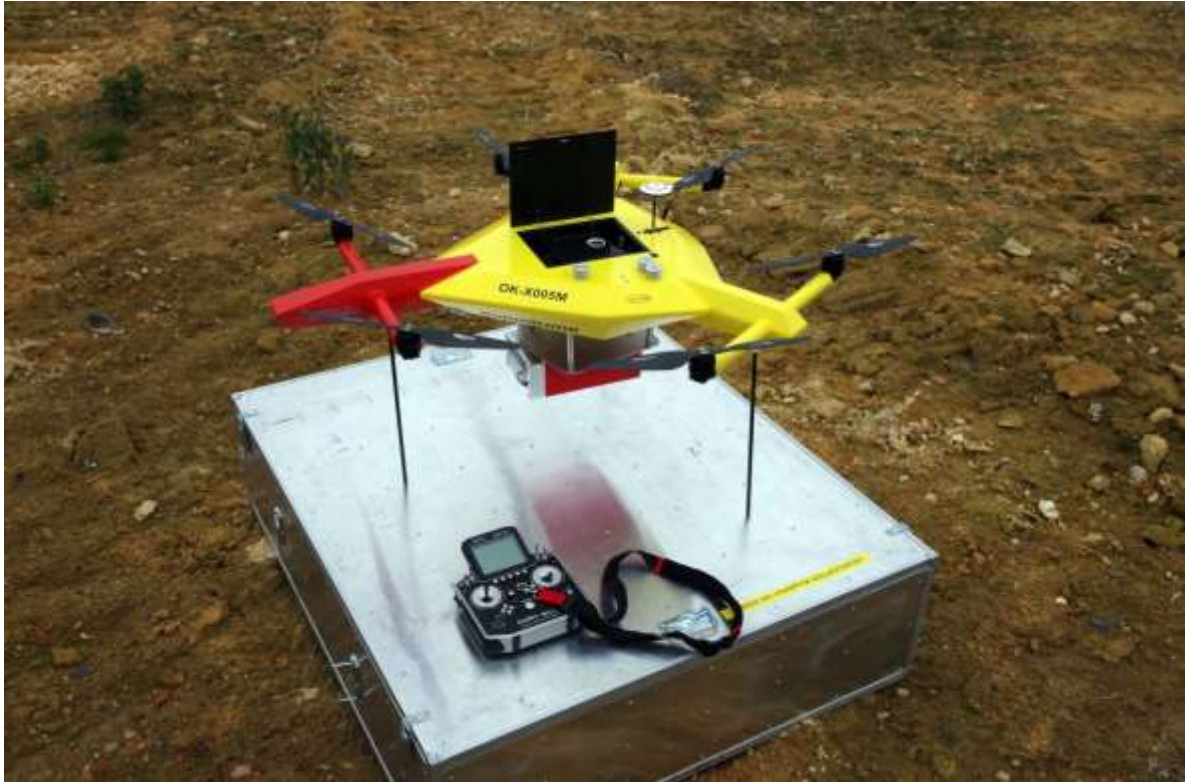
Obrázek 3 - Dron používaný k monitorování radiační situace – zdroj SÚRO, v.v.i
