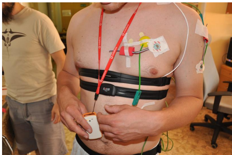
Obrázek 2: Rozmístění senzorů podle SÚJCHBO. Paže a levý prsní sval. Archiv autorů FlexiGuard.
