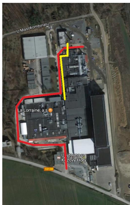
Obrázek 5 - Schéma dopravy uvnitř areálu (červeně) a vedení plynu žlutě (zdroj: google.com)
