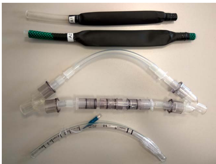
Obr. 3.2: Příklad vyrobené sady rezistorů A. Nahoře dva rezistory s EFL, uprostřed rezistor R_{\text{exp}} > R_{\text{insp}} a dole rezistor R_{\text{exp}} > R_{\text{insp}} .
