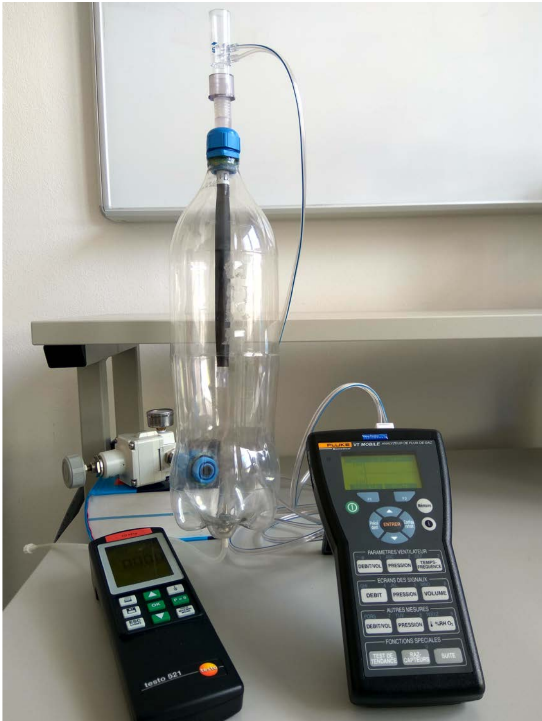
Obr. 2.16: Zapojení celé měřicí soustavy. Soustava je záměrně ve vertikální poloze, protože na rezistor takto nepůsobí nic jiného, než tlak P_{alv} uvnitř komory. Pokud by byla soustava v horizontální poloze, kromě tlaku P_{alv} by na zaškrcení rezistoru měla vliv také jeho samotná váha, což by negativně ovlivnilo měření.
