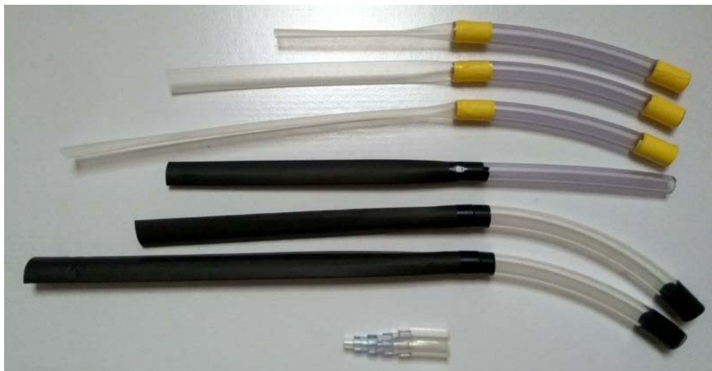
Obr. 2.5: Několik vyrobených rezistorů s EFL o různých délkách a průměrech. Dole: zúžení složené z gumových hadiček o různých průměrech.
