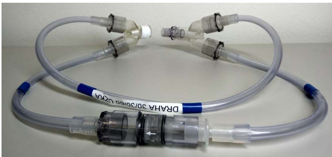
Obr. 2.10: Vyrobený model rezistoru R_{exp} > R_{insp} s jednocestným ventilem. Bílá šipka značí směr propustnosti ventilu (inspirium).
