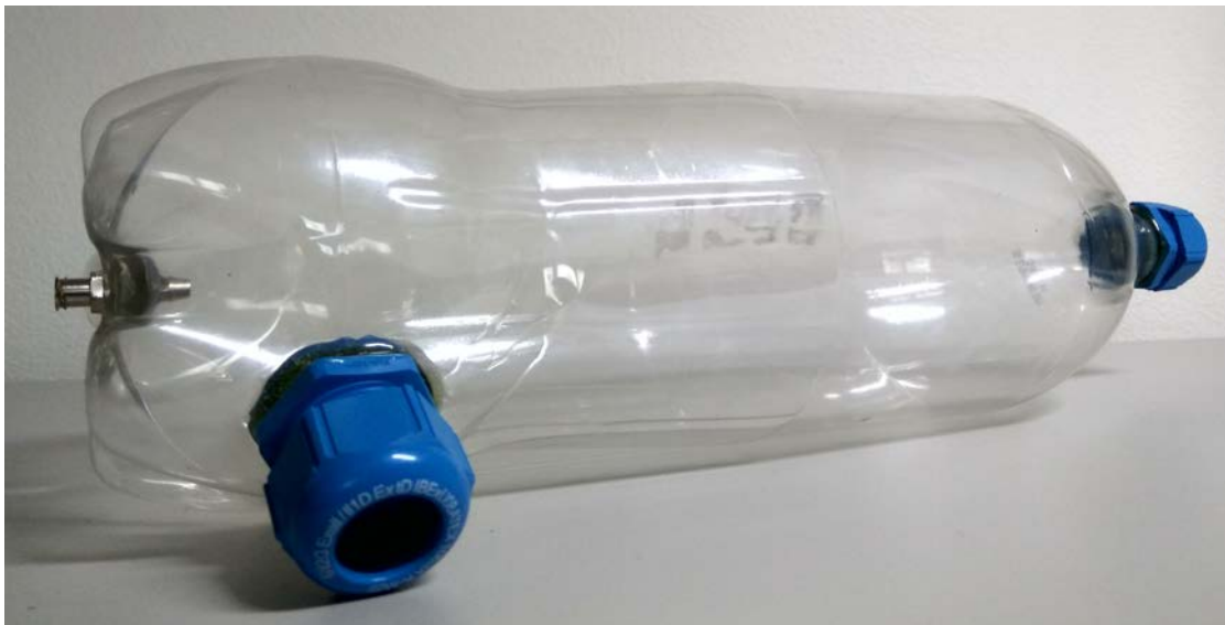
Obr. 2.13: Měřicí komora vyrobená z prázdné PET lahve. Na lahev byly připevněny dvě modré průchodky, které slouží ke vkládání měřené hadičky do lahve a k přívodu či odvodu vzduchu. Další malá průchodka s luerkovým závitem slouží k měření tlaku P_{alv} uvnitř komory.
