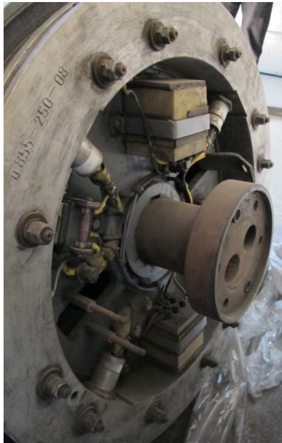
Obrázek 16 - Rotační usměrňovač bezkontaktního budiče typu RBL
