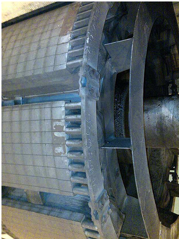
Obrázek 19 - Rotor synchronního motoru 3,2 MW, 2p = 8 , s detailem na amortizér s mezipólovými pružnými spojkami
