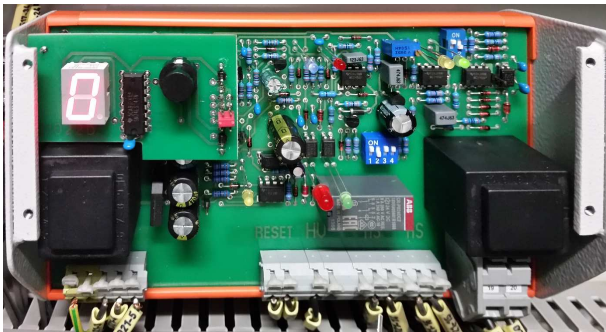
Obrázek 44 - Ochrana proti asynchronnímu chodu PEG 21MD bez předního krytu
