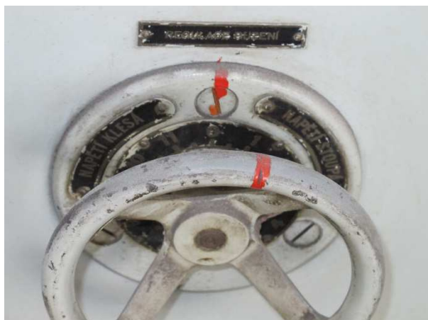
Obrázek 3 - Nastavení budícího proudu derivačního dynama
