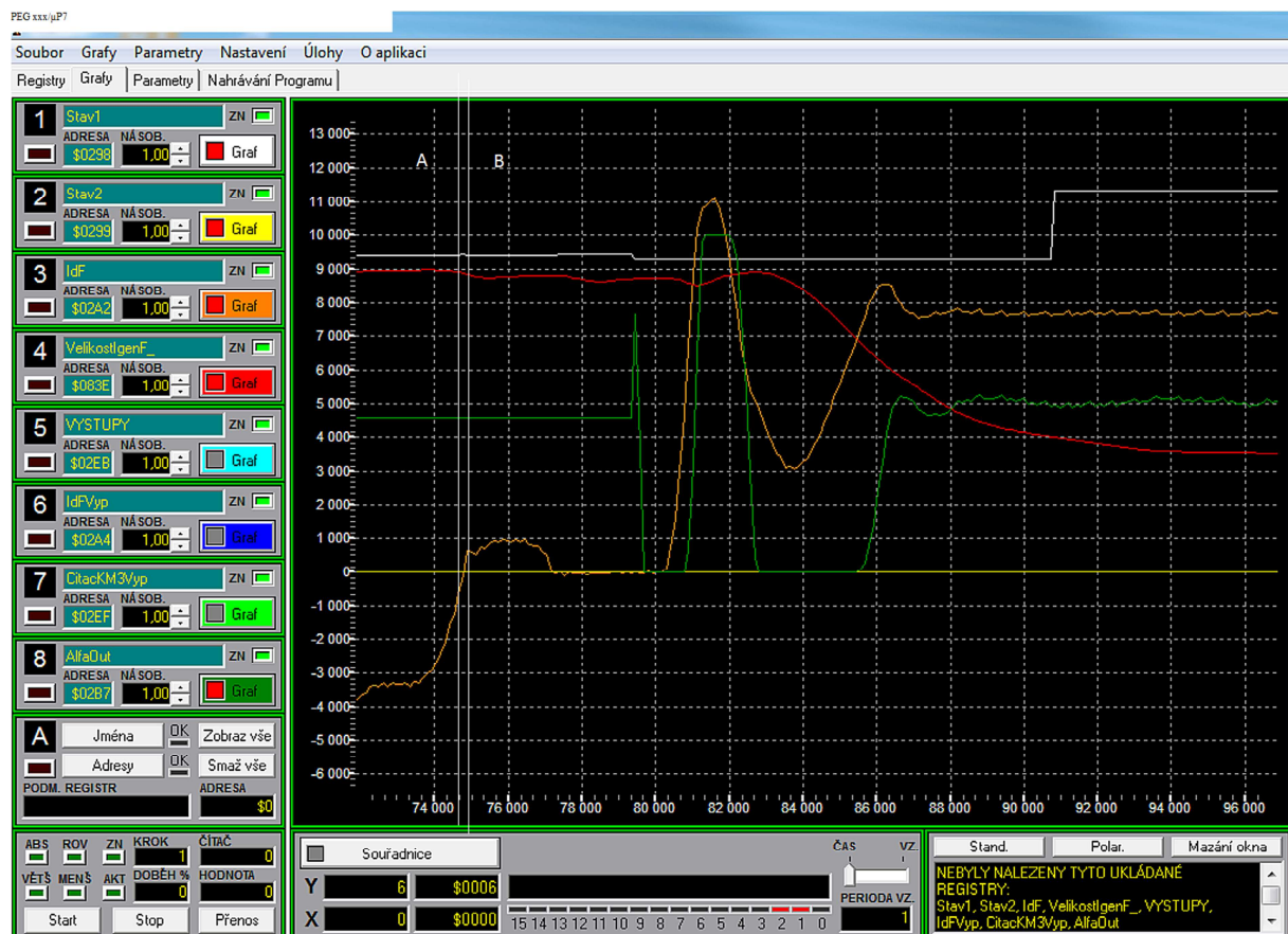
Obrázek 50 - Diagram č. 2 řízeného nabuzení a synchronizace stroje s těžkým rozběhem, detail okamžiku synchronizace
