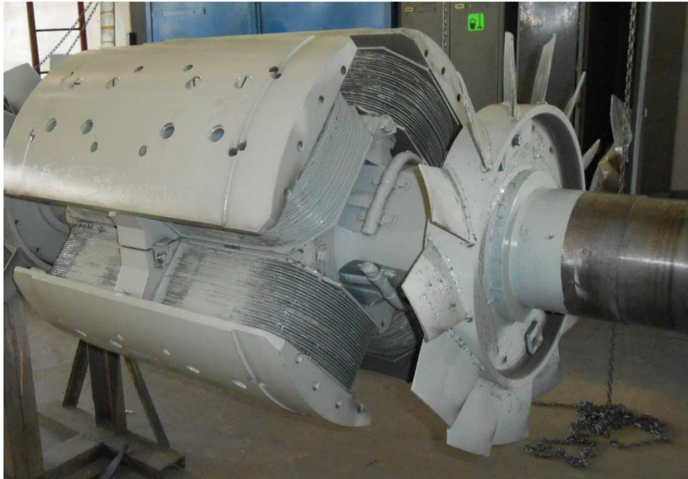
Obrázek 21 - Rotor synchronního motoru 32B 222-04HW1 bez amortizéru
